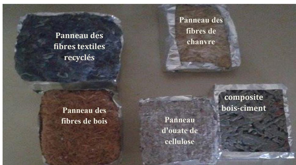
Figure III. 9 : Échantillons de la liste des matériaux fibreux
