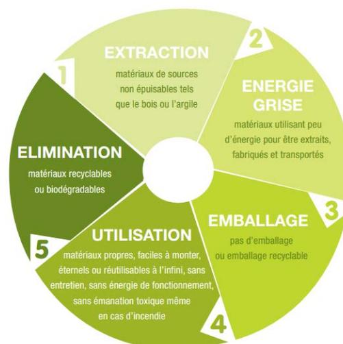
**Figure III. 4: Cycle de vie idéale d'un matériau de construction**
