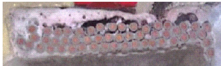
(b) Bobine coupée à son extrémité
