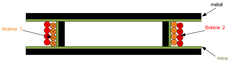
FIGURE 2.29 – Section transversale, la vue schématique d'une bobine double.
