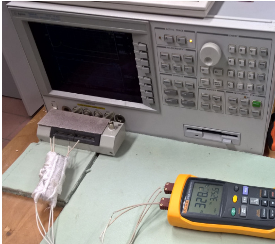
FIGURE 3.58 – Dispositif de mesure de l'impédance de la bobine en HT^{\circ} (vue générale).
