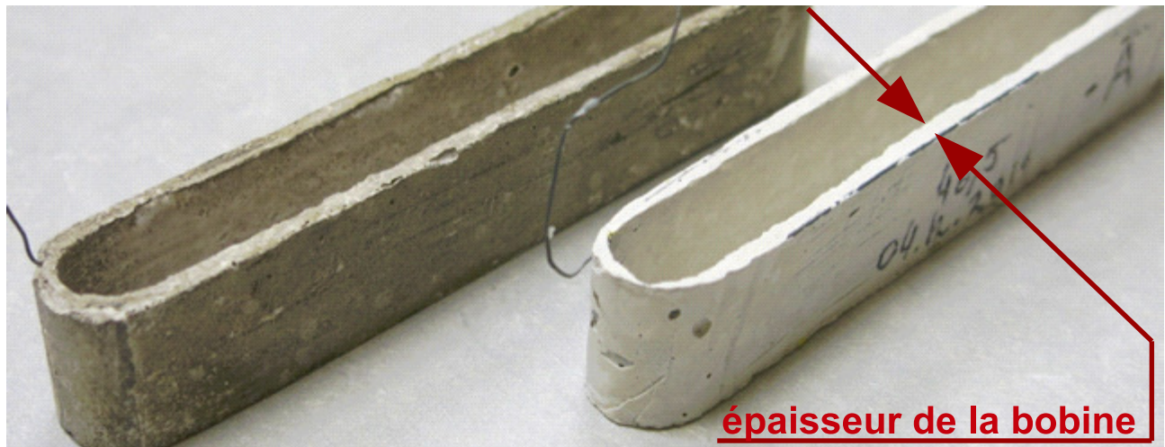
FIGURE 2.34 – Premières bobines inorganiques fines (épaisseur voisine de 3\text{mm} ).
