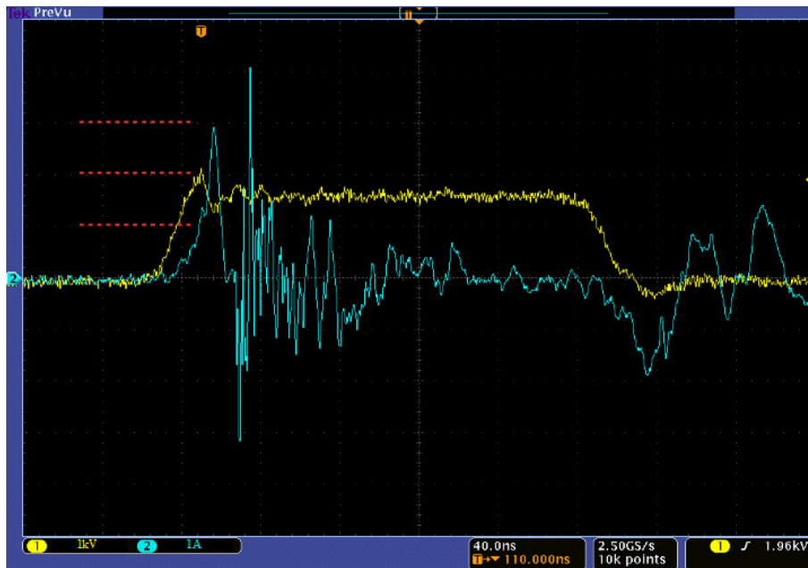
FIGURE 2.50 – Tension impulsionnelle avec l’amplitude de 2,8 kV, l’échantillon sous test est une paire torsadée, avec isolant polymère classique. La présence de nombreuse DP est observée sur le courant.
