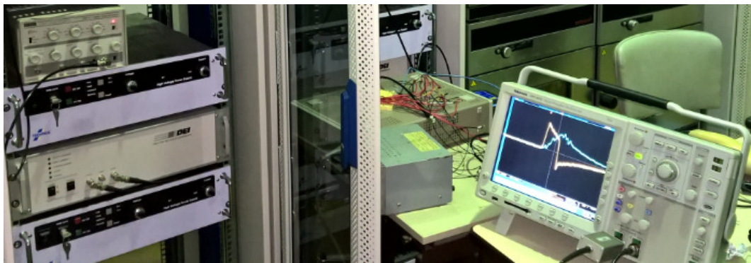
FIGURE 2.49 – Dispositif de mesure en tension impulsionnelle, bobine sous test (photo du haut), générateur d'impulsions haute tension (photo en bas à gauche), mesures tension/courant (photo en bas à droite).
