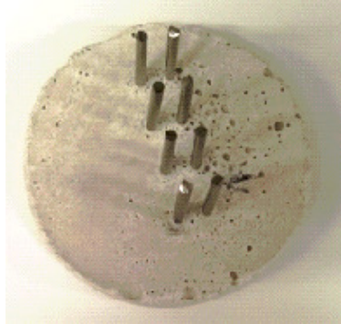
(a) Echantillon avec des électrodes distantes de 6\text{mm} .
