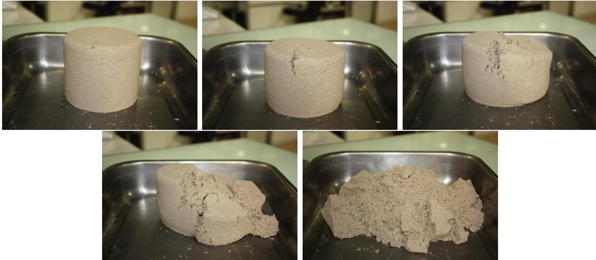
FIGURE 3.4 – Chronologie de l'effondrement d'un p $\hat{a}$ t $\acute{e}$  de sable cinétique, compacté préalablement à  $1.38 \text{ g/ml}$ , correspondant de gauche à droite et de haut en bas aux instants  $t_0$ ;  $t_0 + 10 \text{ s}$ ;  $t_0 + 20 \text{ s}$ ;  $t_0 + 35 \text{ s}$  et  $t_0 + 120 \text{ s}$ .
