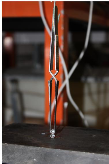
FIGURE 3.19 – Billes reliées par un pont solide de paraffine, mises en place pour un essai de traction à l'échelle microscopique.
