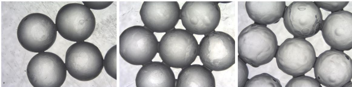
FIGURE 3.5 – Billes de verre borosilicate de  $3 \text{ mm}$  de diamètre avec des teneurs massique en Carbopol de 0.3%, 1.3% et 2% (de gauche à droite). On observe qualitativement que la taille des ponts augmente avec la quantité de gel.
