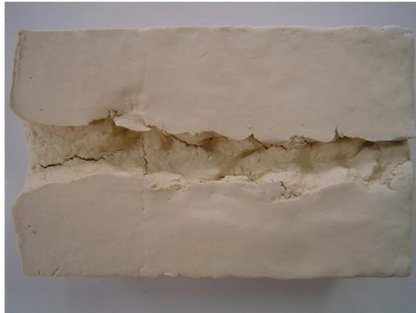
FIGURE 2.15 – Échantillon d'argile après un essai de HET, découpé dans l'axe du conduit.
