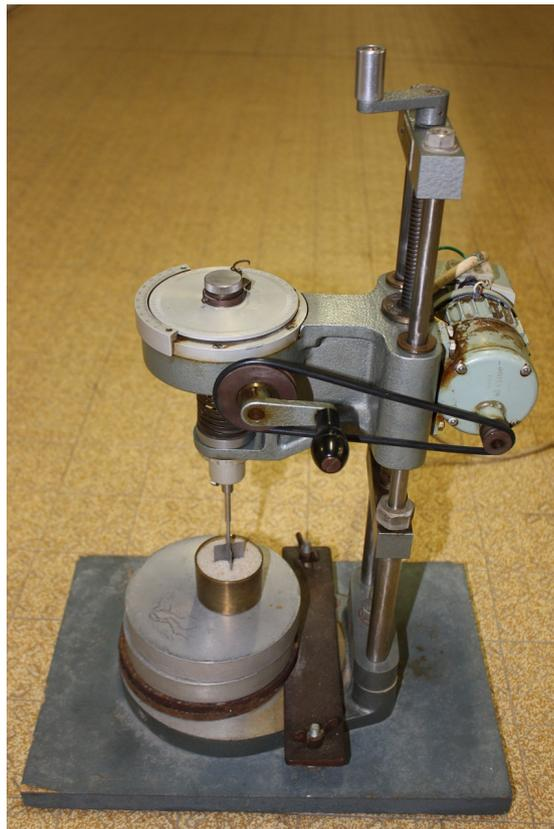
FIGURE 3.26 – Scissomètre du laboratoire de mécanique des sols du centre IRSTEA.
