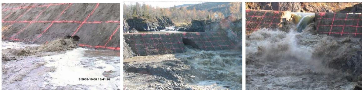
FIGURE 2.5 – Déroulement de la rupture d'une digue expérimentale par érosion interne, initiée par un conduit artificiel traversant l'ouvrage (Höeg et al., 2004).
