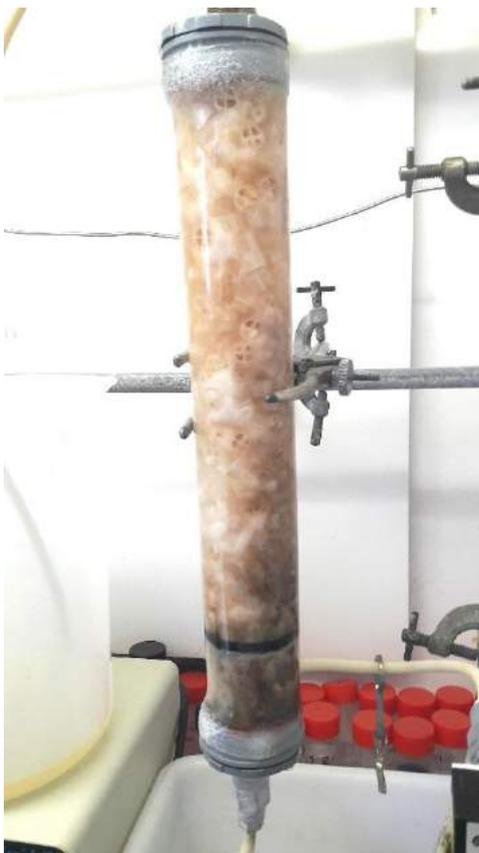
Figure IV-25 : Formation d'un amas brunâtre en bas de réacteur lors du couplage OVH-200°C – PBBR
