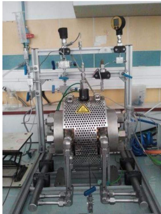
Figure II-2 : Photo du réacteur d'OVH batch
