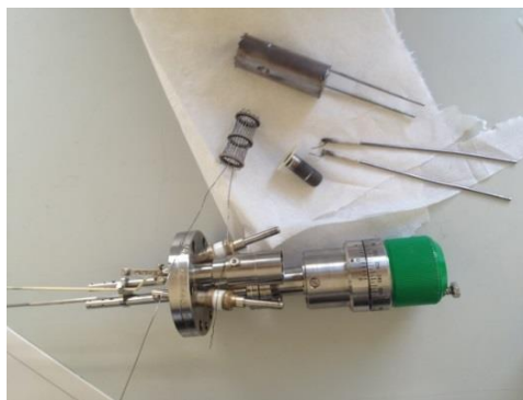
Figure I.12 : Photographie des constituants d'une cellule d'évaporation prise au cours d'une opération de maintenance, après remplacement de dispositif chauffant en tantale.
