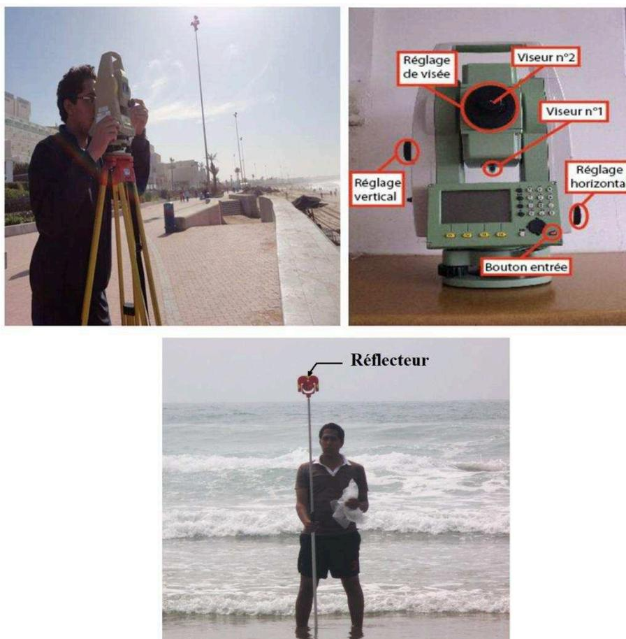
Fig III- 5 : Appareillage de mesure topographique par le tachéomètre électronique TS06
