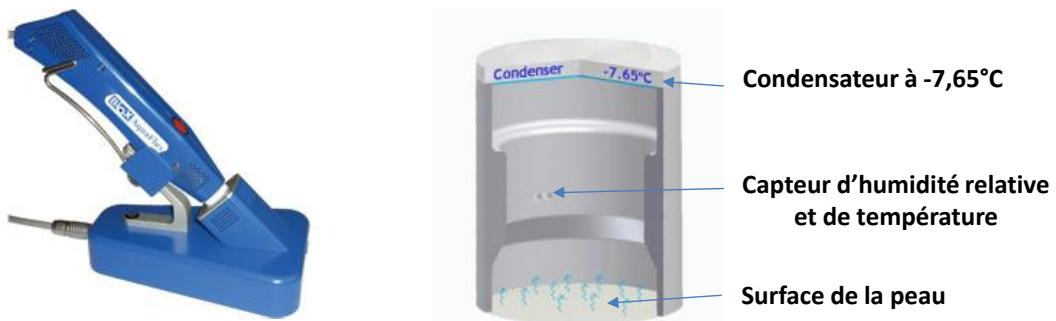
**Figure 30 :** Image photographique de la sonde Aquaflux AF200 (Biox Systems Ltd) (*à gauche*) et schéma de la chambre fermée équipée d'un condensateur (*à droite*).
