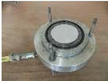
Placer un filtre et un joint
