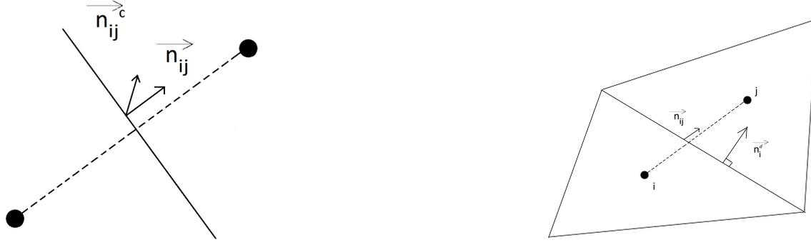
(a) Modification de la direction d'interaction orientant le problème de Riemann par la correction de la consistance d'ordre 0 (b) Normales d'interaction  $\vec{n}_{ij}$  et normales géométriques  $\vec{n}$
