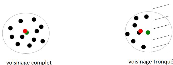
FIGURE 3.4 – Schéma de la procédure de décalage par un barycentre géométrique (vert : particule d'intérêt en  $X_i$ , rouge : barycentre géométrique  $X_G$ )
