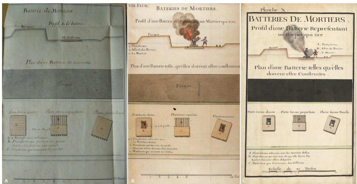
Figure 293 : Planches similaires montrant l'installation de batteries de mortiers d'après Vauban : (A) Mémoire pour le siège de Nice (cl. E. Guilloteau) - (B) Manuscrit conservé au SHD de Vincennes (cl. Jean Vigne) - (C) Manuscrit conservé au CNAM (cl. CNAM).
