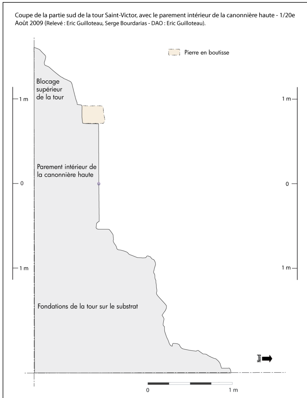
Figure 24 : Profil de la partie sud de la tour Saint-Victor, au niveau de la courtine.
