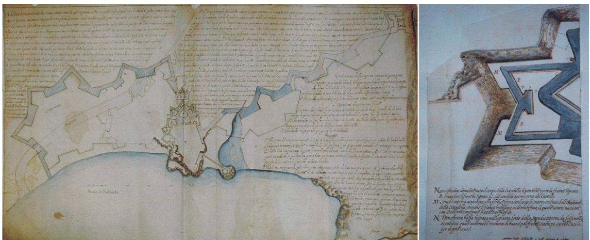
Figure 231 : Plan général de la mise en défense de la ville et du Château de Nice et détail du Château montrant la conservation des cornes de la citadelle, « front marqué B » (cl. aST).
