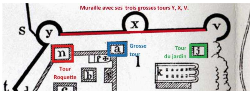
Figure 74 : Restitution par Caïs de Pierlas du front nord du château (DAO E. Guilloteau).
