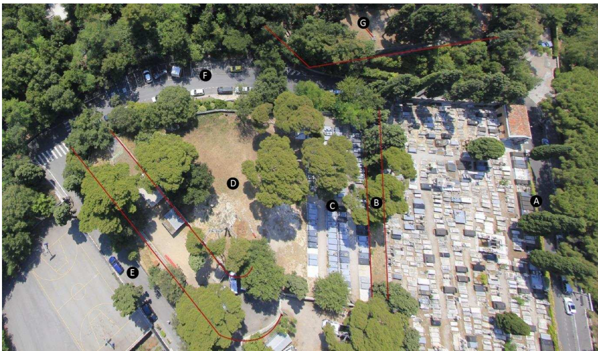
Figure 323 : La Colline aujourd'hui dans le secteur sud de la citadelle. (A) Le mur du cimetière suit l'ancien chemin couvert de l'ouvrage à cornes. (B) La courtine délimite le cimetière israélite. (C) Extension actuelle du cimetière après le comblement du fossé de la demi-lune. (D) Terre-plein de la demi-lune. (E) Fossé de la demi-lune. (F) Fossé du front nord. (G) Terre-plein ayant gardé la forme du bastion neuf occidental et vestige de l'une de ses traverses (cl. P. Behar, DAO E. Guilloteau).
