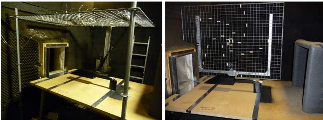
FIGURE 2.11: Positions de l'antenne acoustique : horizontale (à gauche) et verticale (à droite).
