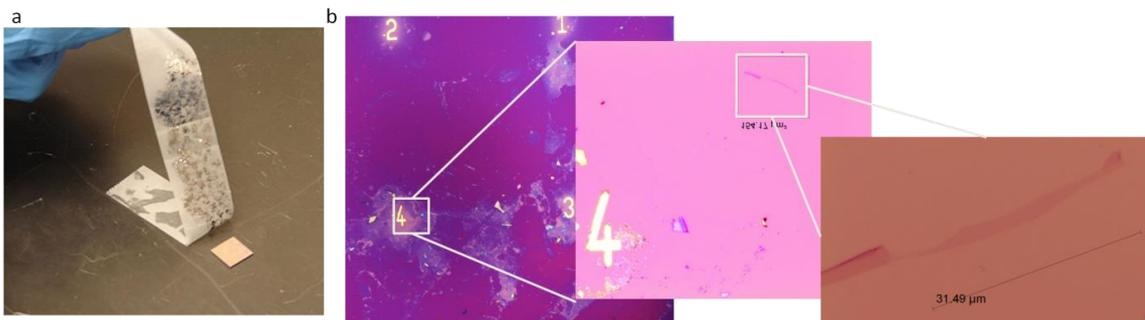
Figure I-19: Méthode d'exfoliation mécanique de graphène à l'aide d'un ruban adhésif et d'un bloc de graphite HOPG (a). Observation optique réalisée à l'IEMN de graphène exfolié reporté sur  $\text{SiO}_2$  (b).
