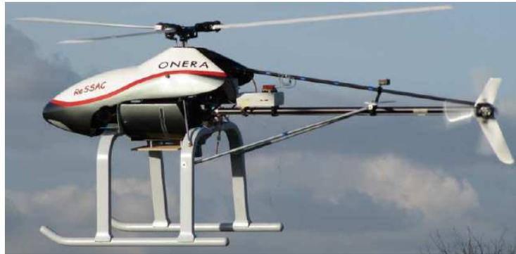
FIGURE 1.23 – Le drone hélicoptère Vario Turbo de l'Onera.
