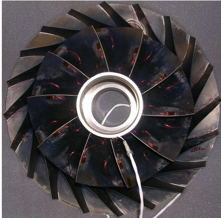
FIGURE 2.14 – Instrumentation en jauges d'extensométrie sur le rouet
