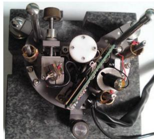
FIGURE C.3: Intérieur de la tête du microscope AFM
