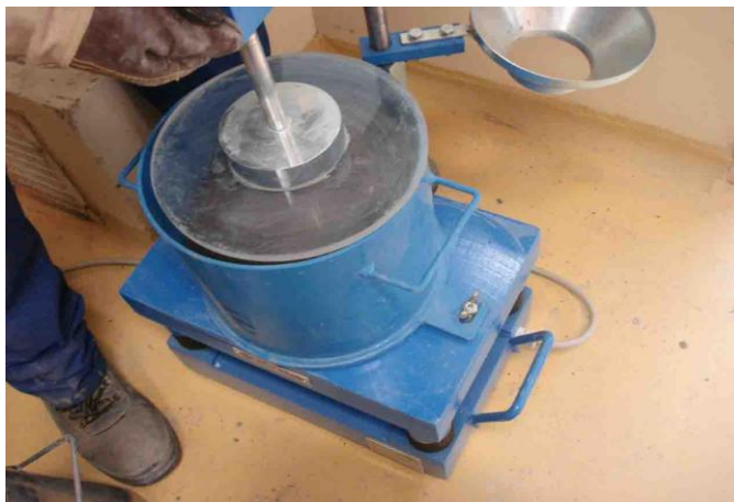
сн. III. 5: Уред на Vebe, за определяне на обработваемостта на бетонната смес
