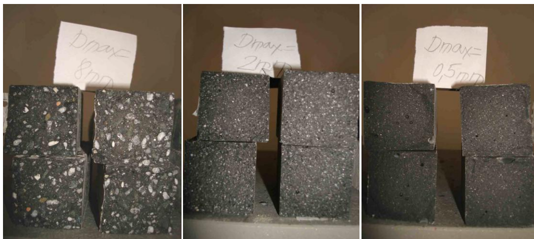
сн. IV. 1: Макроструктура на състави с различен максимален размер на добавъчния материал
