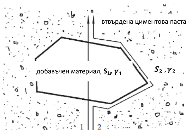
фиг. 1. 11: Схематично представяне на пътя на разрушение на СВЯБ при използване на ЕДМ [Xincheng, 2013]
