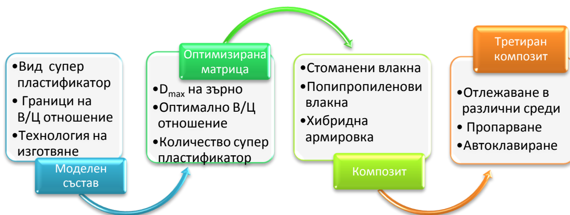
фиг. III. 1: Системен подход при създаването и модифициране състава на СВЯБ
