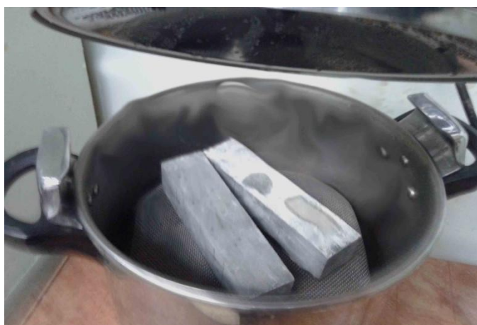
сн. III. 12: Пробни тела гредички 4/4/16 cm, подложени на пропарване в продължение на 48 часа
