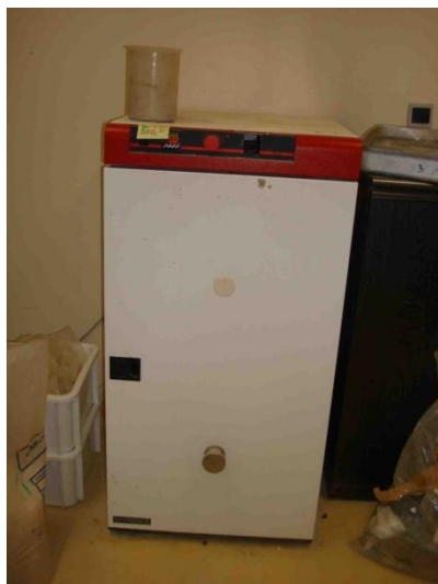
сн. III. 9: Камера за отлежаване при 10 0 С
