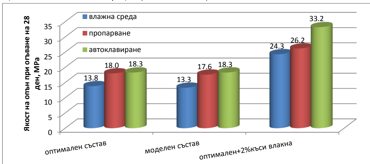
фиг. VI. 31: Влияние на топло-влажностната обработка при различни състави върху якостта на опън при огъване
