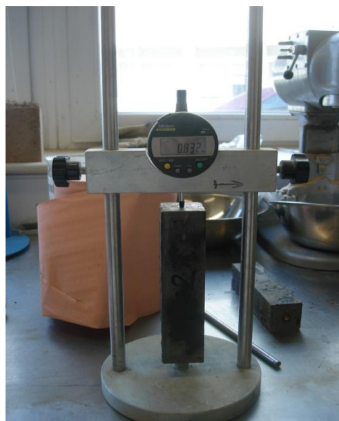
сн. III. 21: Електронен уред за измерване на съсъхването на пробни тела гредички 4/4/16 см
