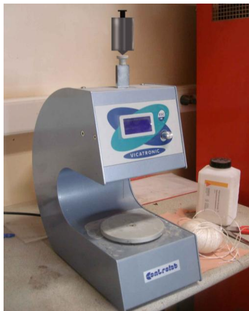
сн. III. 7: Електронен уред на Вика за определяне начало свързване на разтвори
