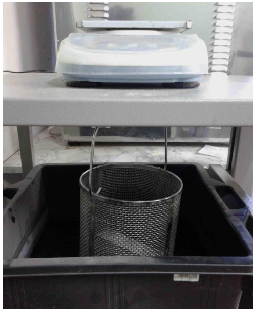
сн. III. 17: Хидростатична везна за определяне на обемна плътност на пробни тела гредички 4/4/16 cm
