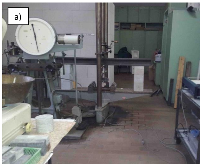
сн. III. 29: Опитни постановки за определяне на връзката между натоварване и деформация (вертикално провисване и надлъжна деформация в опънна зона) на пробни тела призми 4/4/16 cm, посредством а) преса с натоварване по сила и б) преса с натоварване по деформации
