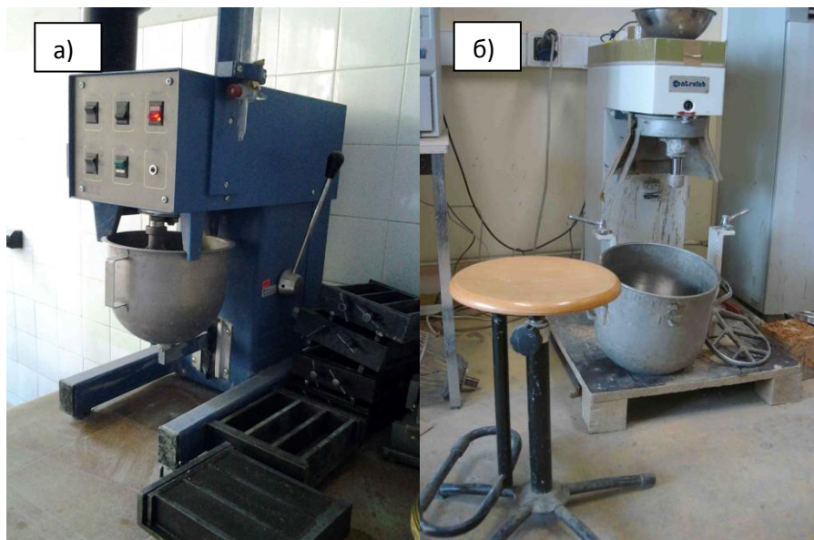
сн. III. 3: Миксери за приготвяне на бетонна смес: а)4л; б)20л
