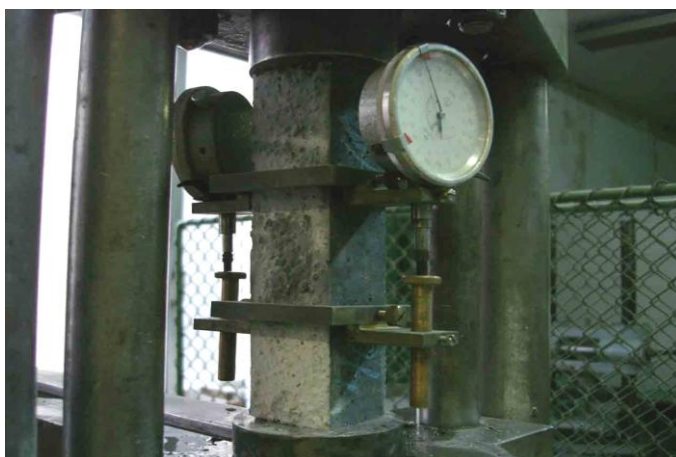
сн. III. 27: Изпитване модула на еластичност на пробни тела гредички 4/4/16 cm
