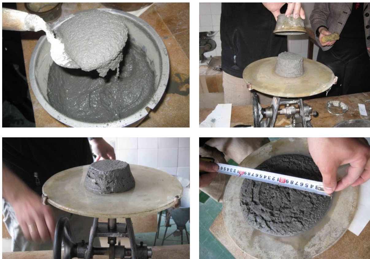
сн. III. 2: Определяне на пластифициращия ефект от различни химически добавки
