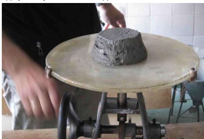
сн. III. 4: Стръскваща маса, за определяне на обработваемостта на бетонната смес
