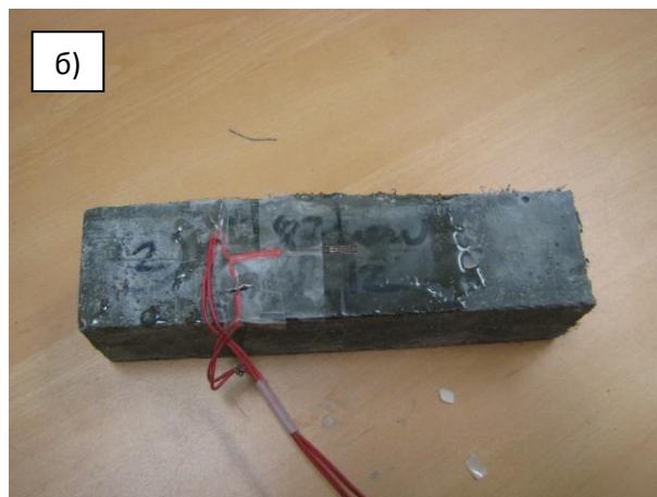
сн. III. 31: Определяне на надлъжната деформация в опънната зона на пробни тела гредички 4/4/16 см., посредством а) индуктивен датчик и б) съпротивителен датчик
