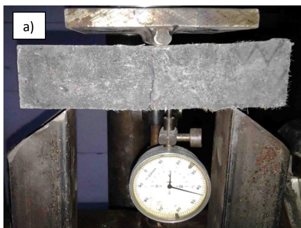
сн. III. 30: Определяне на провисването при огъване на пробни тела 4/4/16 cm, посредством: а) индикаторни деформометри б) цифров запис на полученото провисване
