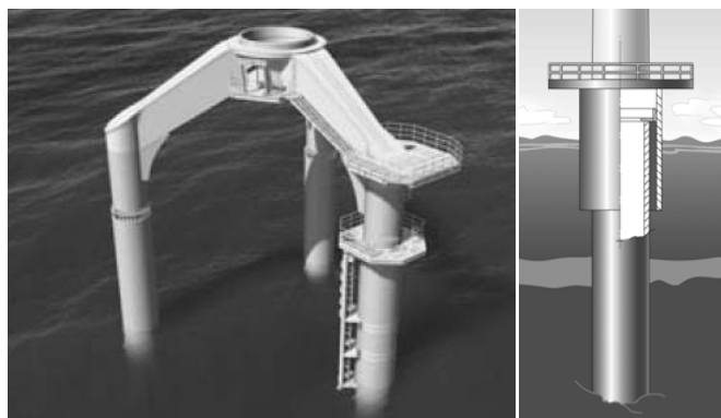
пр. 1 сн. 23: Основи на турбини за производство на електроенергия чрез вятър намиращи се под вода (2006), Дания [Moeller, 2008]
