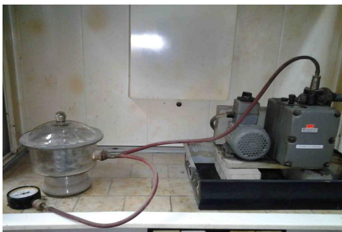
сн. III. 19: Пробни тела 4/4/16 cm, потопени във вода, в ексикатор, свързан с вакуум помпа
