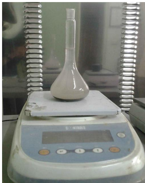
сн. III. 18: Пикнометър за определяне на специфична плътност на бетона, предварително смлян до ситност на частиците под 200 \mu\text{m}
