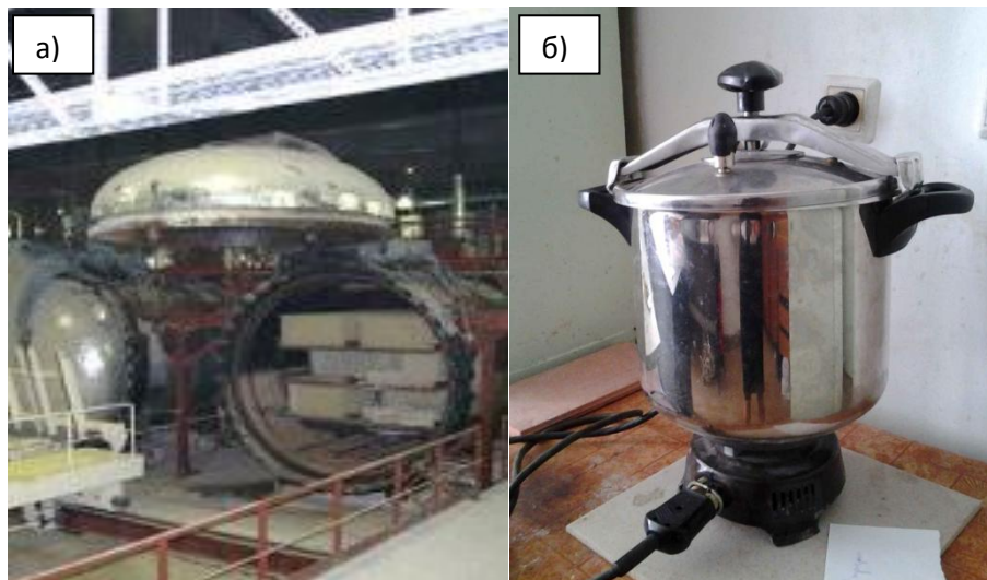
сн. III. 13: Пробни тела 4/4/16 см, подложени на автоклавна обработка в а) заводски условия; б) лабораторен автоклав
