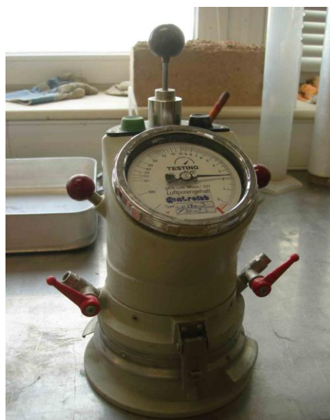
сн. III. 6: Уред за определяне съдържанието на въздух
