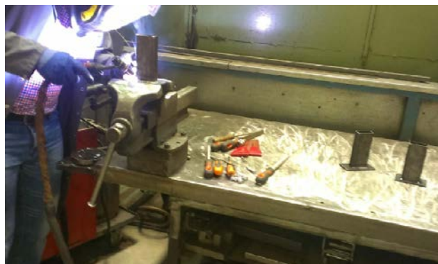
Fig. 5.114. Opération de soudure des échantillons.
