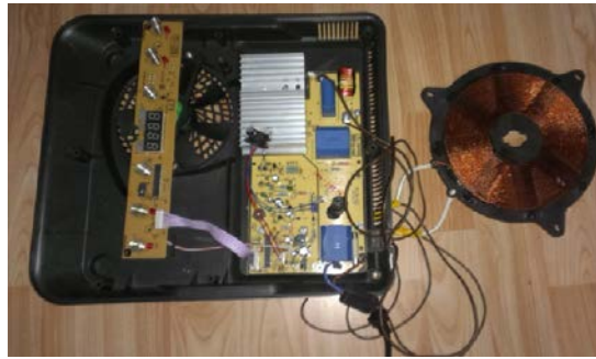
Fig. 5.111. Installation d'échauffement des échantillons par induction.
