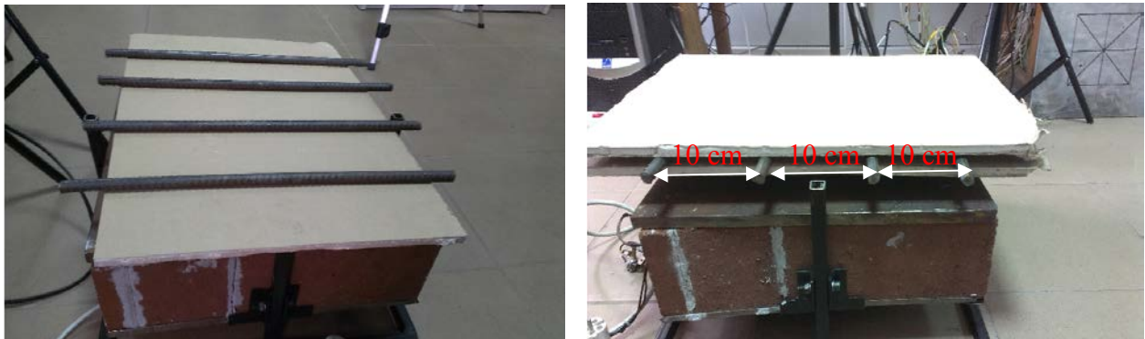
Fig. 3.1. Montage des barres d'armature entre les plaques de plâtre.
