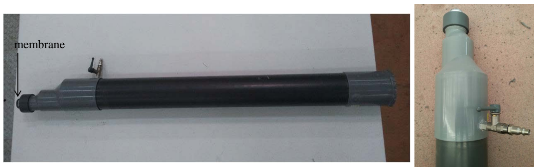
FIGURE 3.4 – Tube à choc "réservoir" T100.
