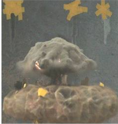
FIGURE 2.7 – Dispersion explosive d'une couche de particules de magnésium de 240\ \mu\text{m} de diamètre. La vitesse moyenne du front de particules durant les premières millisecondes est d'environ 85\ \text{m/s} . Cette image est extraite des travaux de D.L. Frost et al. [27].
