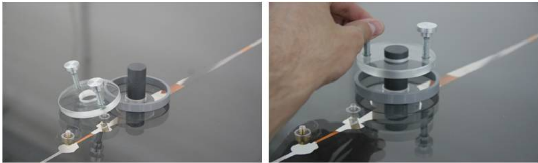
FIGURE 3.12 – Outils de fabrication des anneaux de particules.
