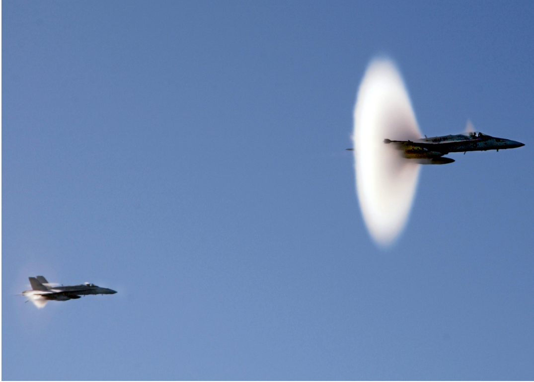
FIGURE 2.1 – Onde de choc conique sur un avion de chasse, volant à vitesse supersonique, rendue visible à cause de la condensation. Le nuage est dû à la singularité de Prandtl-Glauert [12].
