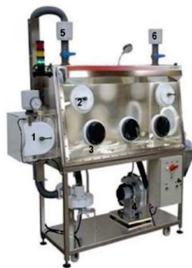
Figure 92 Boîte à gants faisant office de chambre de test d'un volume de 0,8 m 3 équipée : d'un double SAS (1), de hublots équipée de gants (2 et 3) ; d'un système de dépressurisation (4) et d'un filtre HEPA (5) ; ainsi que d'un système de repressurisation également équipé d'un filtre HEPA (6)
