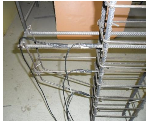
Figure 3-4 : Protection des jauges
