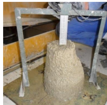
Figure 2-4: Mesure de l'affaissement du béton
