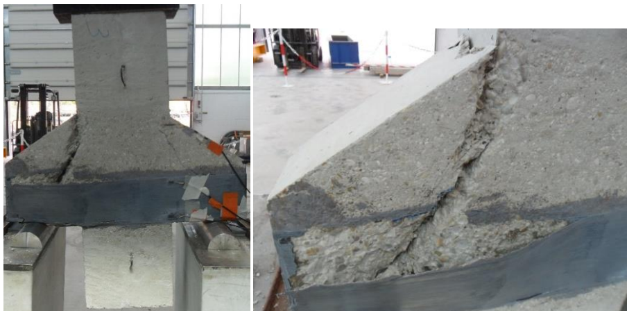
Figure 3-63 : Rupture de console renforcée par bandage, 3 couches unidirectionnelles - CB3u
