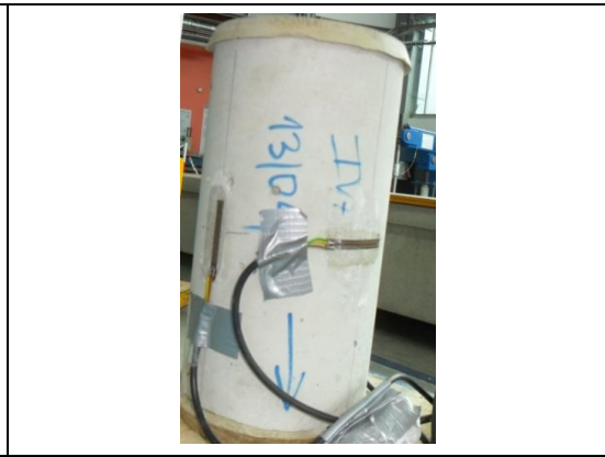
Figure 2-8: Position des jauges de déformation sur l'éprouvette
