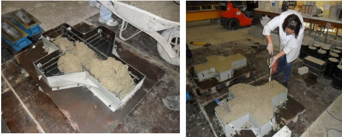
Figure 3-5 : Mise en place du béton
