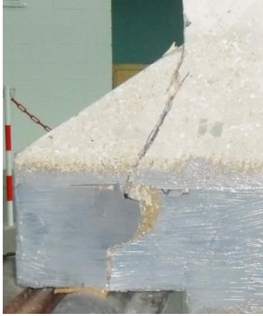
Figure 3-80: Rupture du matériau composite
