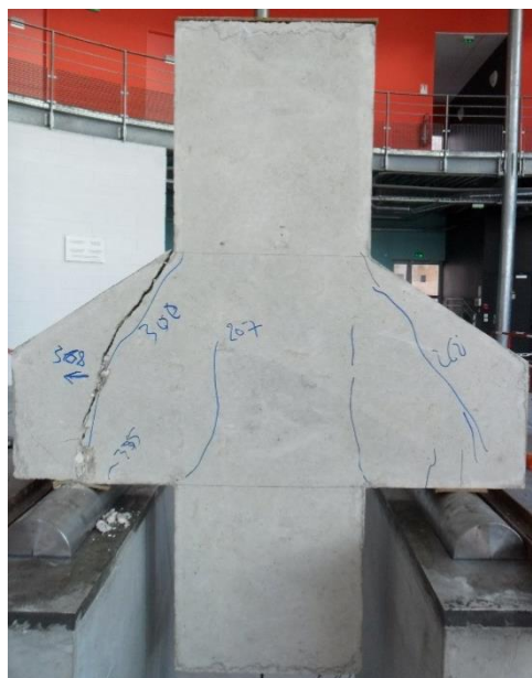
Figure 5-12: Sous chargement monotone jusqu'à la rupture
