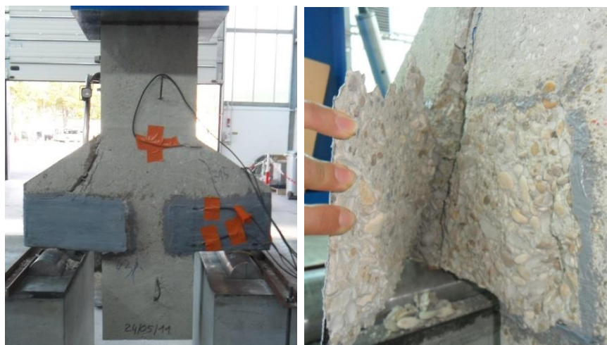
Figure 3-72 : Rupture de la console renforcée par plaque en forme U+, 3 couches unidirectionnelles – CU+3u
