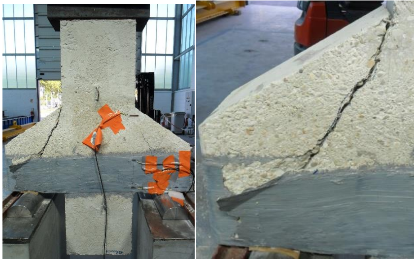
Figure 3-61 : Rupture de la console renforcée par bandage, 1 couche unidirectionnelle - CB1u
