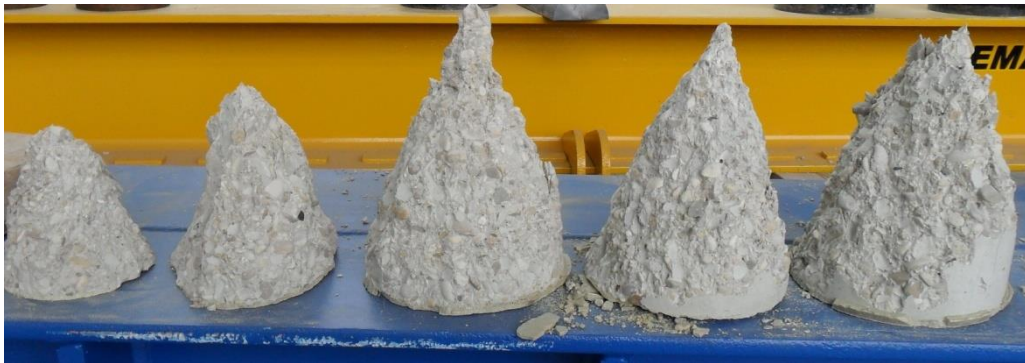
Figure 2-11 : Forme conique caractéristique de la rupture d'éprouvettes cylindriques en béton
