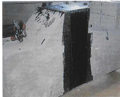
Figure 1-29: Modèle expérimental non renforcé [COR 01] Figure 1-30: Modèle renforcé par CFRP [COR 01]
