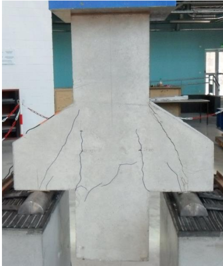
Figure 5-10: Après un million de cycles d'une console en béton armé non renforcée
