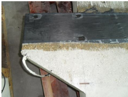
Figure 3-8 : Mise en place des jauges sur matériau composite et sur le béton
