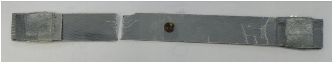
Figure 2-20: Rupture d'une éprouvette composite en fibres de carbone unidirectionnelles sollicitée en traction
