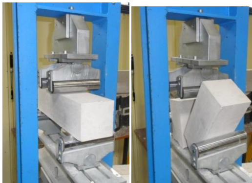
Figure 2-12: Dispositif pour l'essai de traction par flexion 4 points sur les éprouvettes prismatiques et l'éprouvette après la rupture
