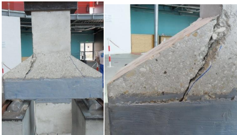
Figure 3-65: Rupture de la console renforcée par bandage, 2 couches bidirectionnelles - CB2b
