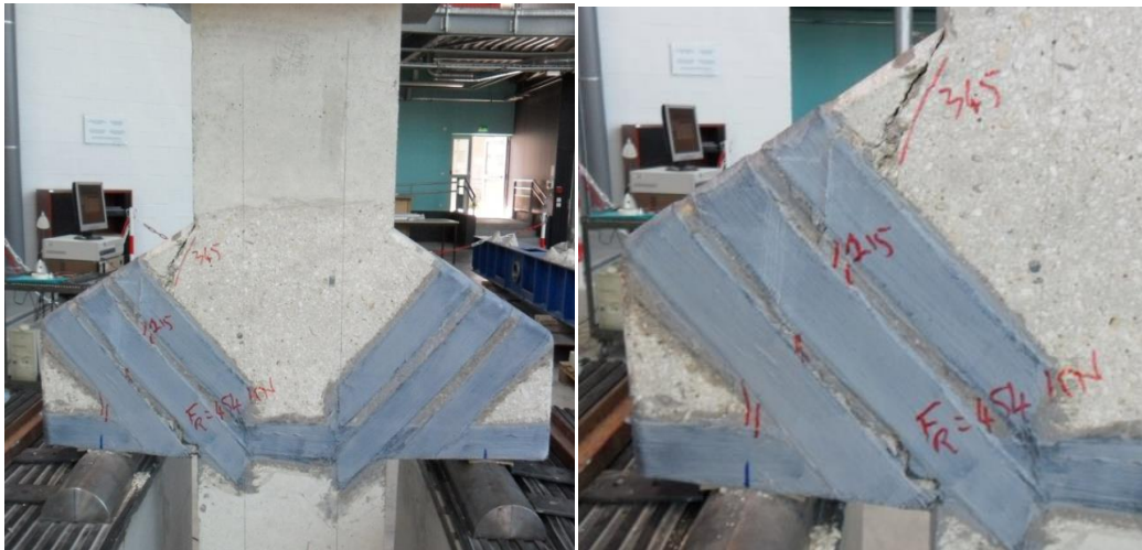
Figure 3-77 : Rupture de la console renforcée par bandes inclinées en forme de U des deux faces plus bandage 3 couches unidirectionnelles de 5cm de largeur (CIU2b+B3u(5cm))
