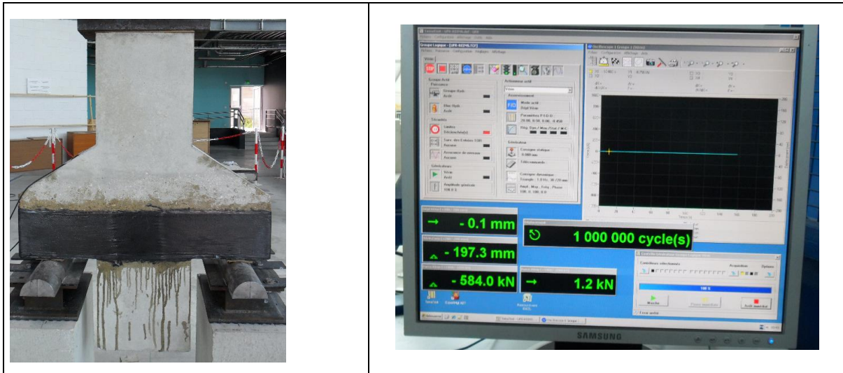
Figure 5-14: Après 1 million de cycles d'une console renforcée.
