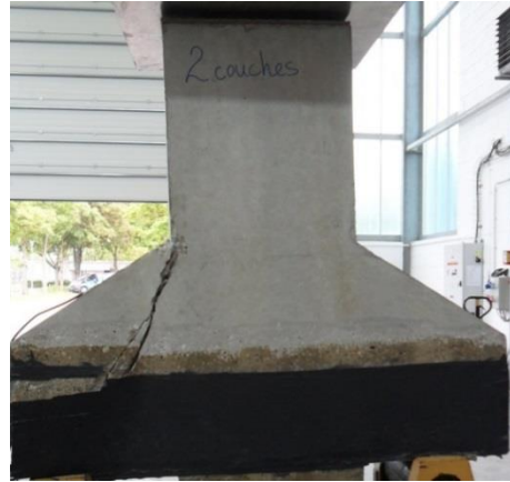
Figure 3-81: Rupture par fendage et décollement à l'extrémité de la plaque
