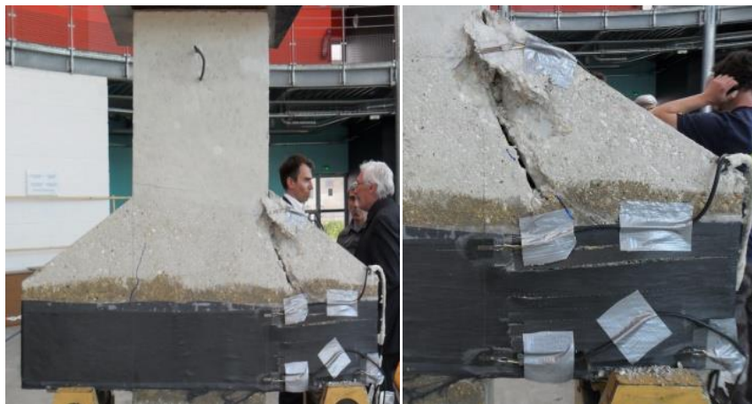
Figure 3-62 : Rupture de la console renforcée par bandage, 2 couches unidirectionnelles - CB2u
