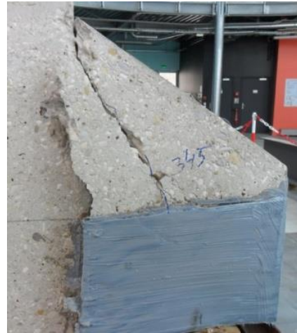
Figure 3-83: Rupture par cisaillement
