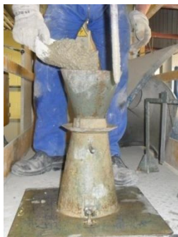
Figure 2-3: Remplissage du cône d'Abrams
