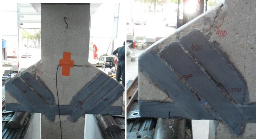
Figure 3-76 : Rupture de la console renforcée par bandes inclinées des deux faces plus bandage 3 couches unidirectionnelles de 5cm de largeur (CI2b+B3u(5cm))
