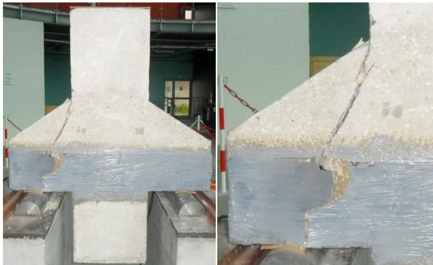
Figure 3-67 : Rupture de la console renforcée par plaques de deux côtés, 1 couche unidirectionnelle - CP1u
