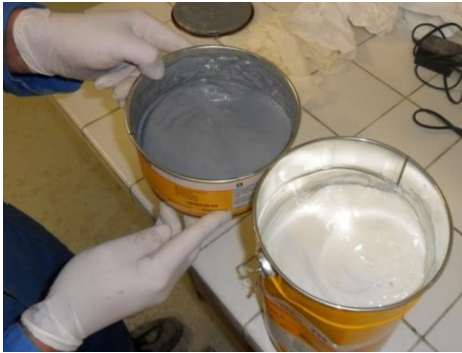
Figure 2-25: Résine époxyde thixotrope à 2 composants, composant A – « blanc » et composant B – « gris »
