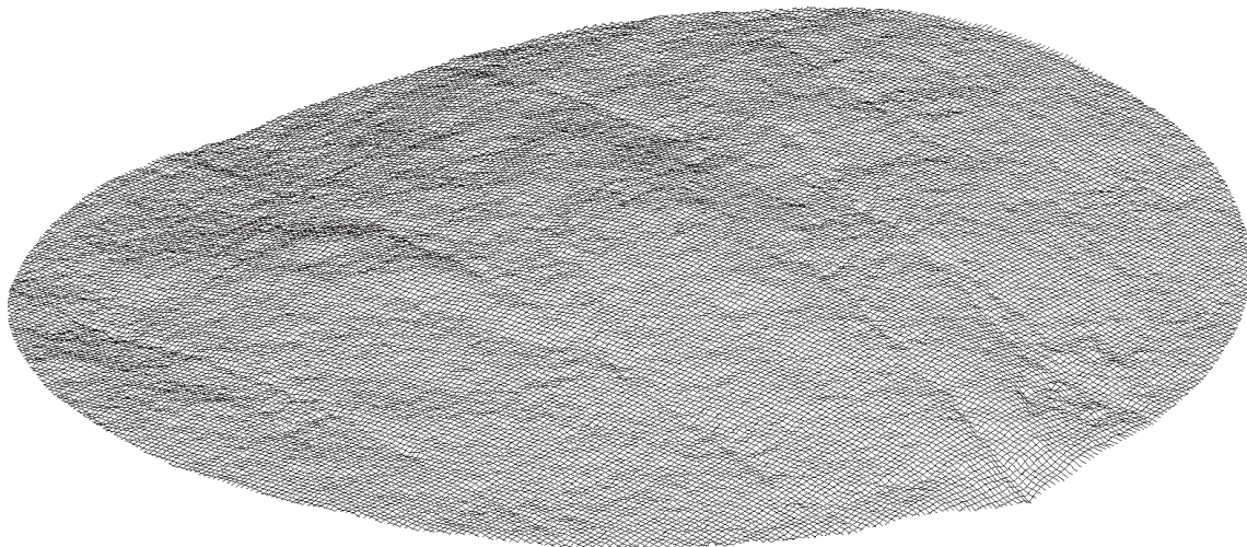
Figure II.24 : Numérisation d'une surface rugueuse sur un maillage régulier.
