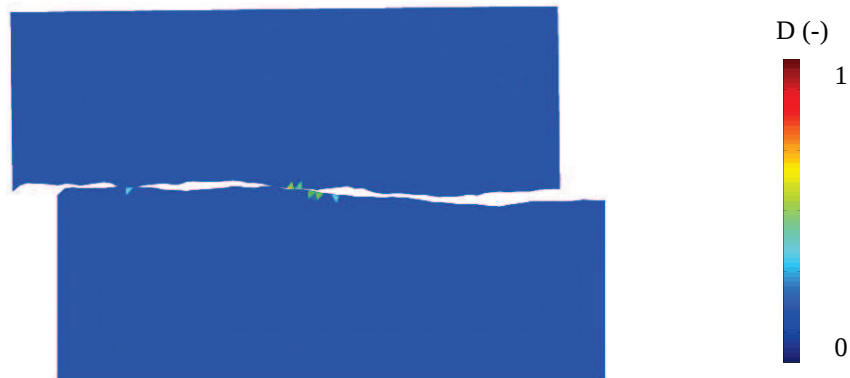
Figure III.32 : Représentation de l'endommagement pour un déplacement tangentiel de 5 mm avec les conditions aux limites initiales.
