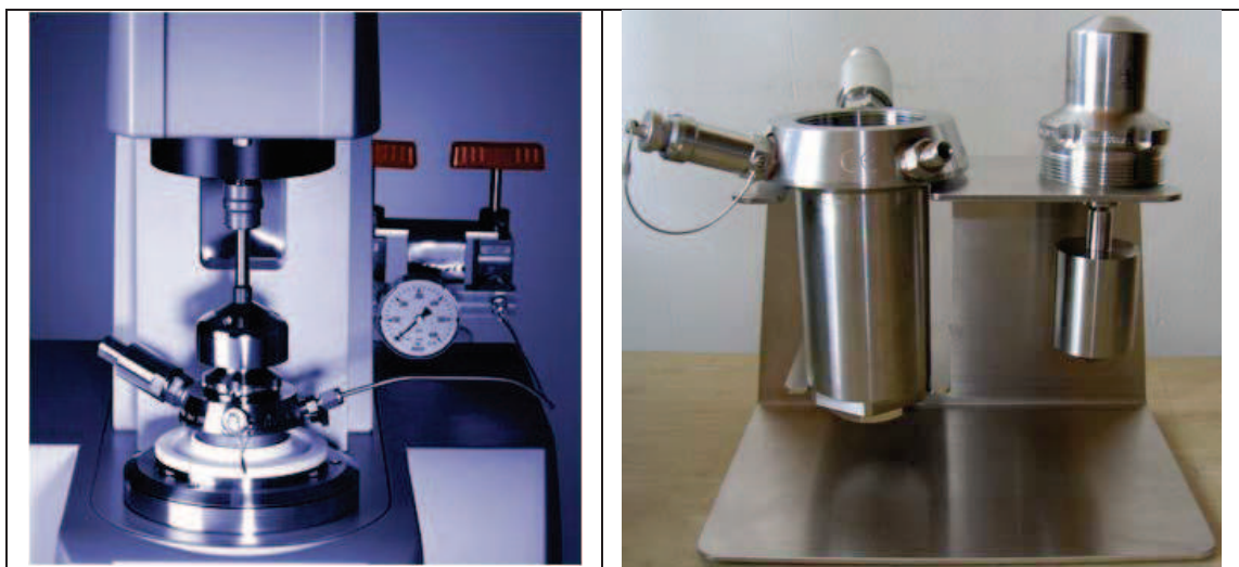
Figure 4-8 : Rhéomètre équipé de la cellule haute pression et la cellule haute pression ouverte.
