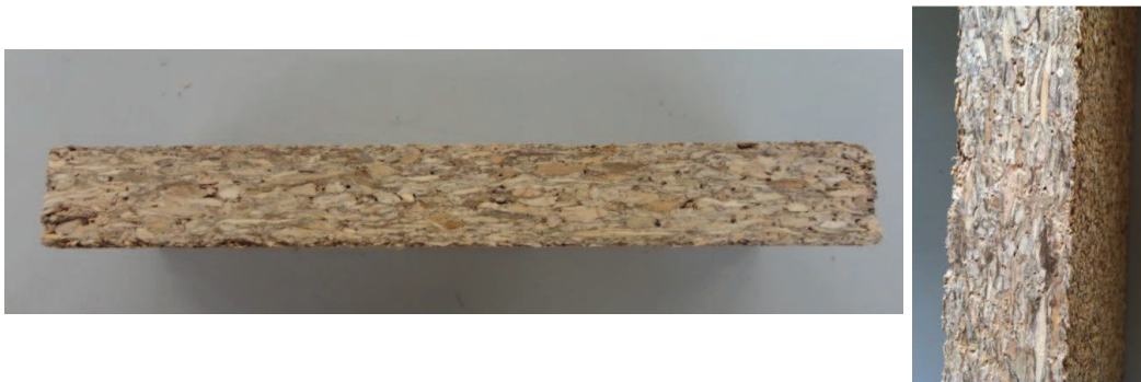
Figure 3-23 : Tranche d'un panneau de particules encollé à 10% avec la résine 0.3-30D10T à 170°C
