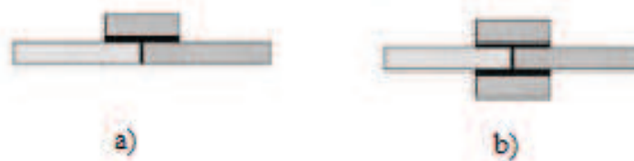
Figure 3-11 : a) Joint bord à bord à recouvrement simple b) Joint bord à bord à double recouvrement symétrique
