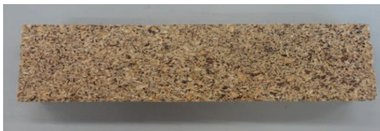
Figure 3-24 : Face d'un panneau de particules encollé à 10% avec la résine 0.3-30D10T à 170°C
