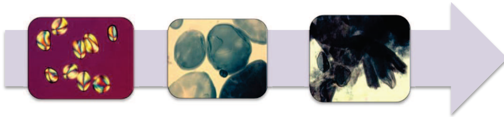
Figure 1-37: Granules crus, gonflés et éclatés de pomme de terre (grossissement x120) [75]
