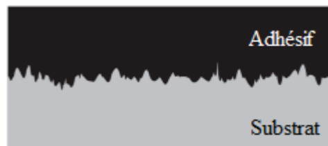
Figure 3-3 : Ancrage mécanique d'un adhésif sur un substrat
