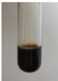
Figure 2-25 : Gélification d'une résine dans un tube à essai
