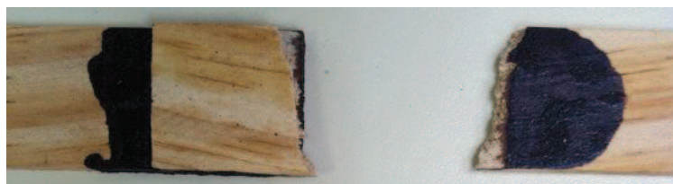
Figure 3-9 : Exemple d'une rupture cohésive dans le bois
