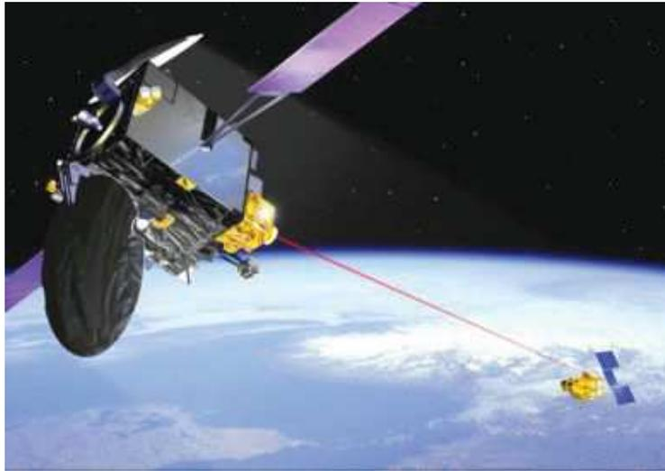
FIGURE 5 – Illustration d’une communication intersatellite par voie optique
