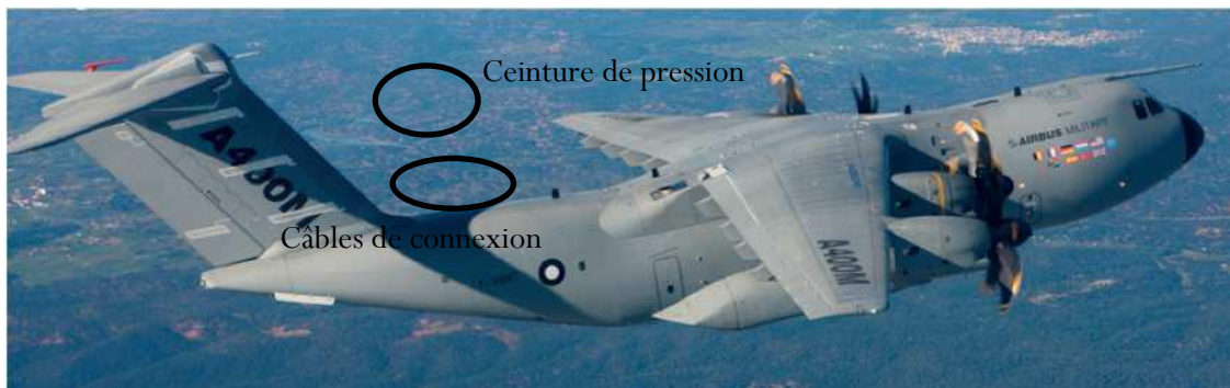
FIGURE 6 : A400M EQUIPE DE CAPTEURS DE MESURE DE PRESSION PENDANT UN VOL D'ESSAI
