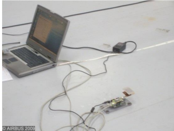
FIGURE 23 : CARTE WISAIR AVEC ANTENNE LAAS SUR LA VOILURE D'UN A340-600
