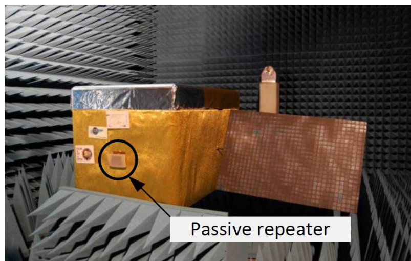
FIGURE 31 : MAQUETTE UTILISEE POUR LA VALIDATION : LAAS-SAT
