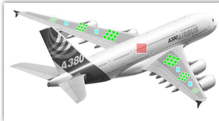
FIGURE 10 : SYSTEME SANS FIL DE MESURE D'UN PROFIL DE PRESSON AUTOUR D'UN AVION ET DE LA REPOSE MECANIQUE D'UN SATELLITE
