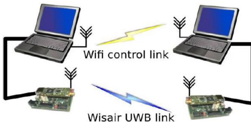
FIGURE 130 : SCHEMA DE PRINCIPE DES COMMUNICATIONS DU LOGICIEL DE TEST
