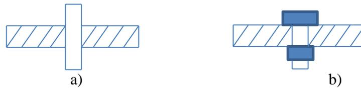
Figure 140. Différents types d'essais de compression troués habités réalisés
