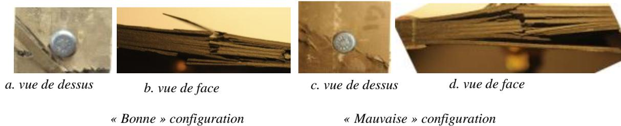
Figure 164 Faciès de rupture des éprouvettes de compression trou non habité
