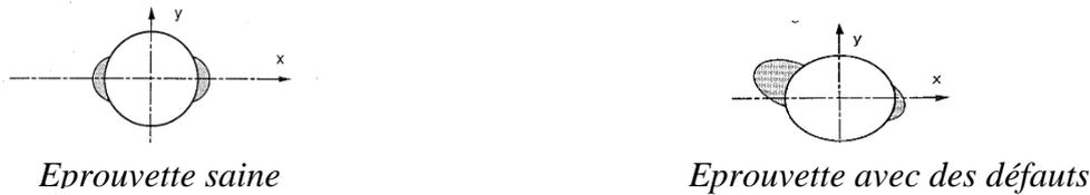
Figure 45. Localisation des déformations maximales (GUEGAN, 1994)
