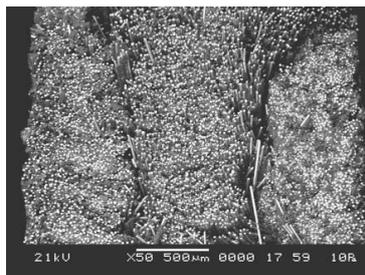
Figure 36 Fibres dépassant de la surface usinée dans la configuration  $+45^\circ$
