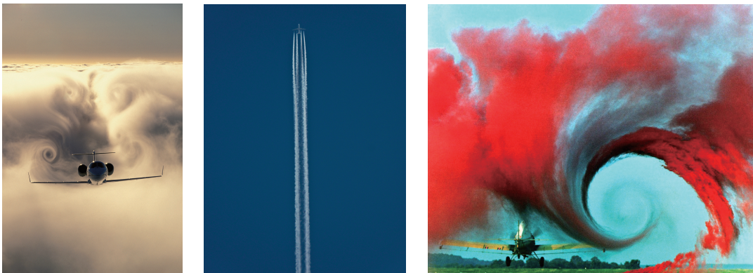
(a) Turbulences de sillage derrière un Learjet 60 dans un nuage [2] de (b) Matérialisation des turbulences de sillage sous forme de traînées de condensation [3] des (c) Turbulences de sillageensemencées de fumées colorées lors de tests effectués par la NASA [4]
