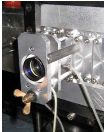
FIGURE 6.2 – Flasque au banc Mercato. Tuyaux d'injection d'air et de diazote.
