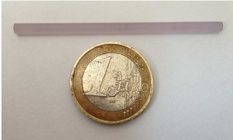
FIGURE 4.3 – Photographie d'une fibre cristalline en Nd :YAG. Diamètre 3 mm. Longueur 60 mm. Dopage 0,6%.
