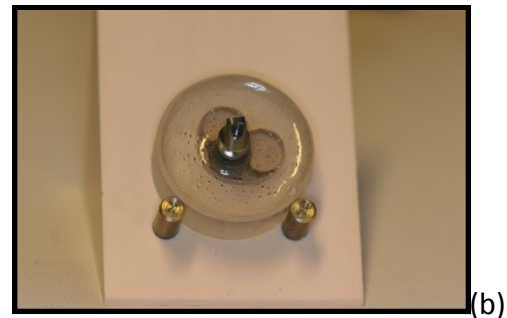
Figure 46. Socle incliné à 45° comportant deux tiges métalliques permettant le calage en pression verticale des échantillons. a) vue de profil, b) vue de face.
