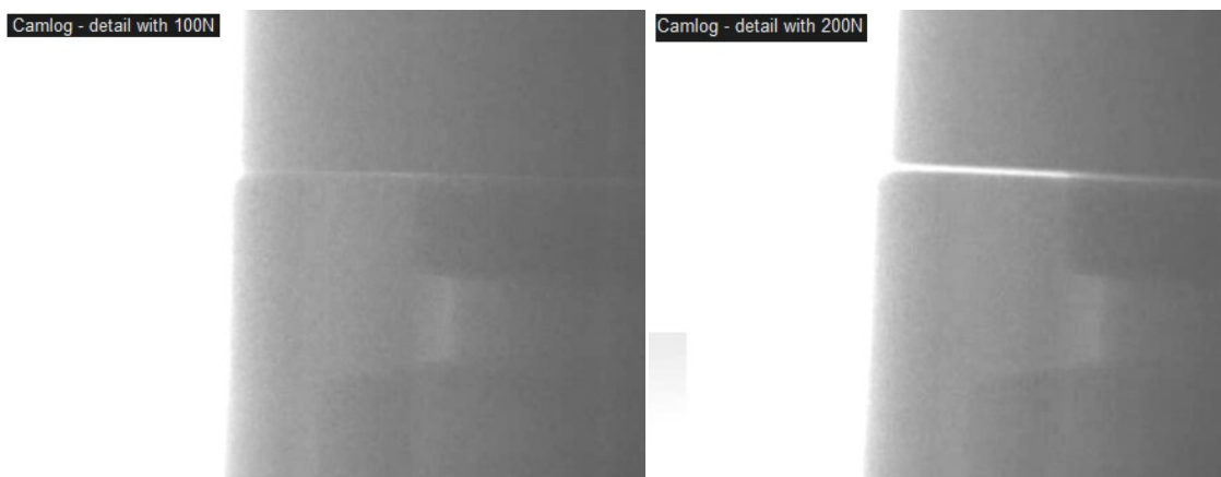
Figure 44. Formation d'un hiatus sous contrainte (source : Weigl - http://www.kgu.de/zzmk/werkstoffkunde/ ).
