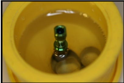
Figure 45. Implant Tapered Screw-vent – Zimmer® positionné dans un moule plastique recevant une résine epoxy.
