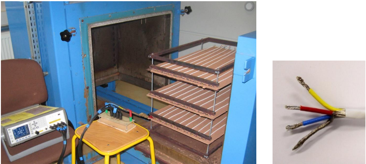
Figure III.9. Système de mesure de la capacité du câble
