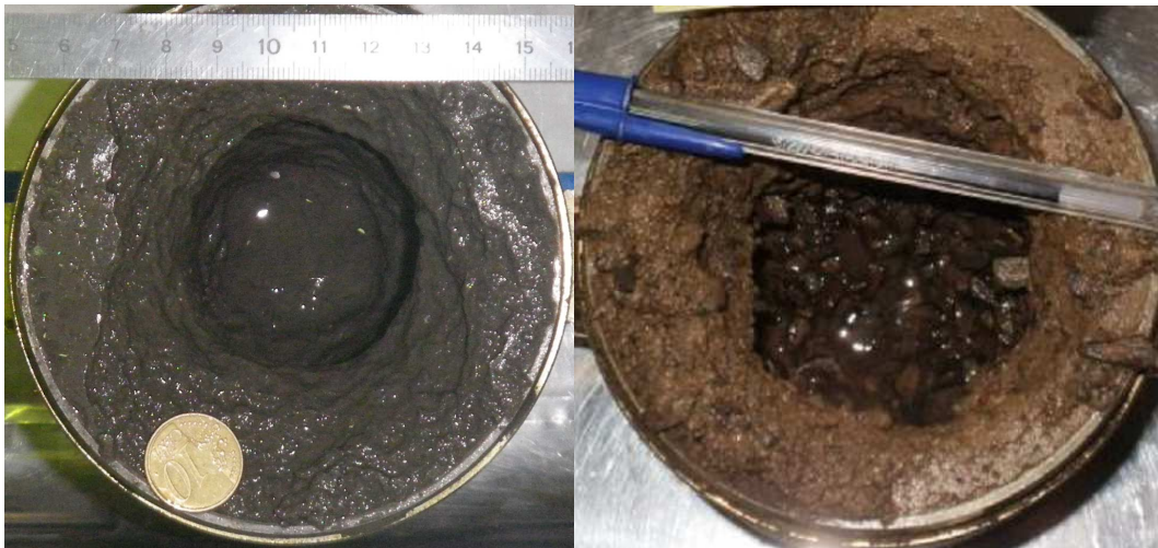
Figure 2.2. Illustration des allures types de figures d'érosion obtenues à la suite d'essais de Jet Erosion Test (C. Moras - geophyConsult).
