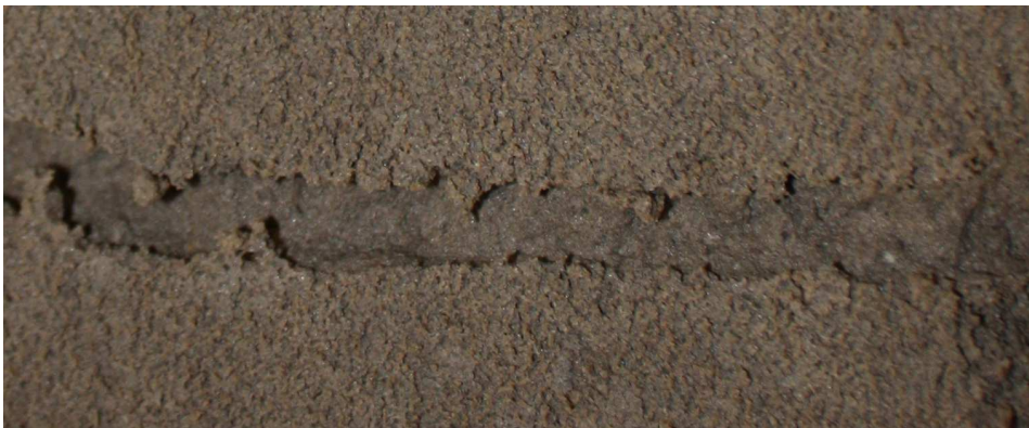
Figure 4.34. Illustration de profils type de figure d'érosion obtenue à la suite d'essais de HET (F. Byron, IRSTEA).
