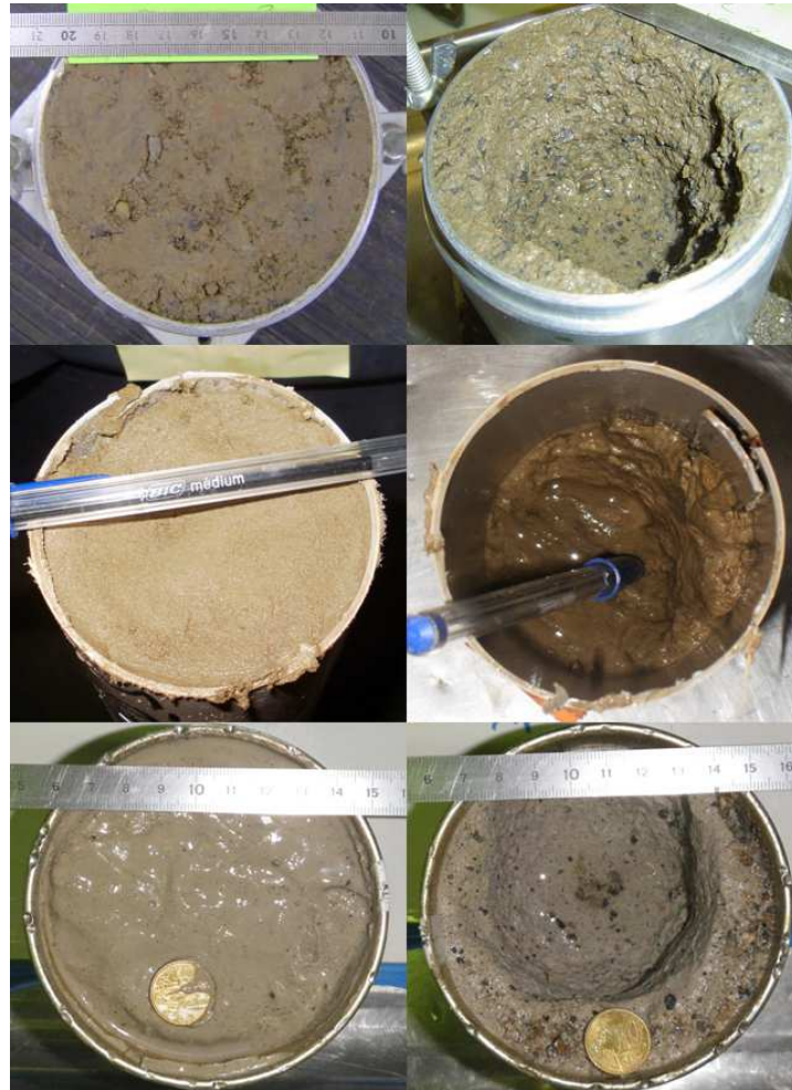
Figure 3.25. Photographies des échantillons de sols avant (à gauche) et après (à droite) essais de JET, avec de haut en bas les images correspondant respectivement aux sols A, B et C.
