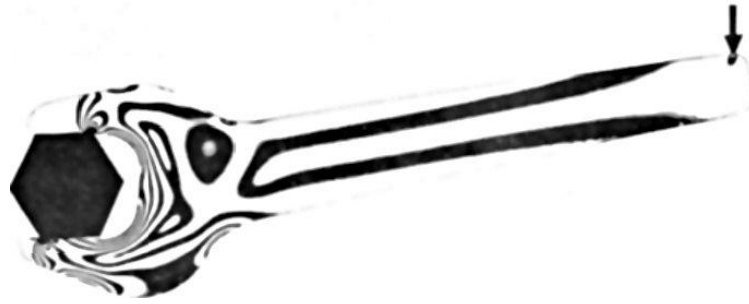
Fig. I-3 : Frange d'interférence lors d'une expérience de photoélasticité
