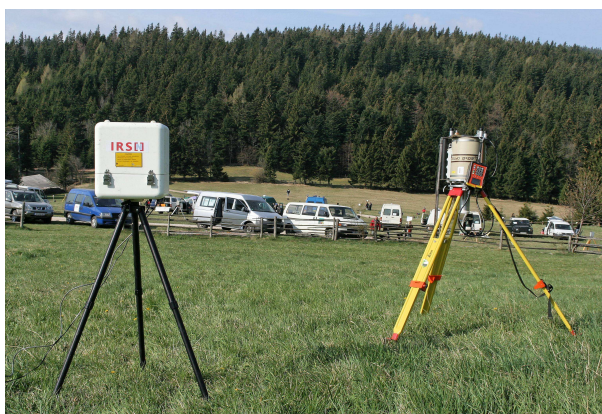
figure 1-2 : utilisation de la spectrométrie gamma in situ avec le détecteur germanium à droite et la chambre à ionisation à gauche (voir 1.3.3).
