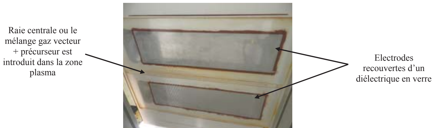
Figure 14. Photo présentant l'électrode supérieure recouverte par le diélectrique.
