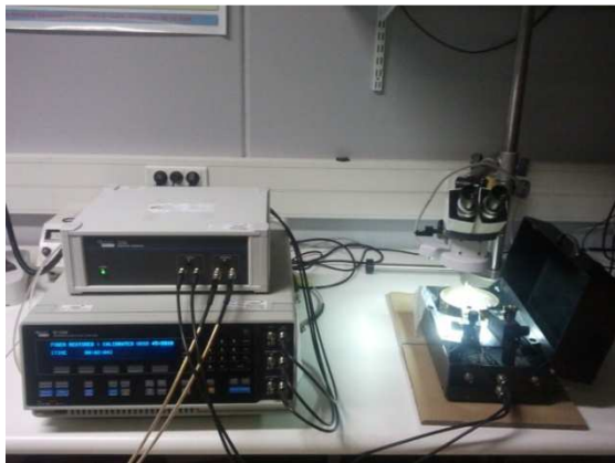
figure II-6 : Solartron 1260 +1296 connecté à un prober sous pointe
