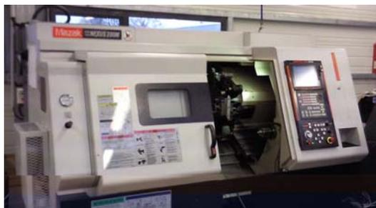
Figure 3.1 : Tour à Commande Numérique MAZAK 200M (UNIVERSAL 500)
