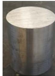
Figure 3.2 : Bloc usiné en acier inoxydable AISI 304L (Diamètre 100 mm ; longueur 120 mm)
