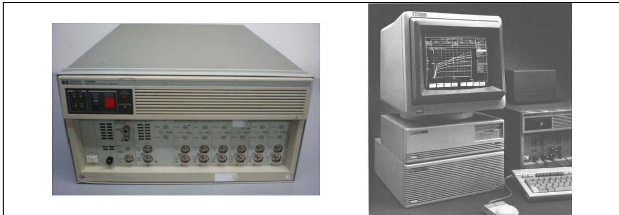
Figure 2-5: Alimentation HP 4142B (à gauche) couplée à un ordinateur HP IMA (à droite) [ @AGI, @TES].
