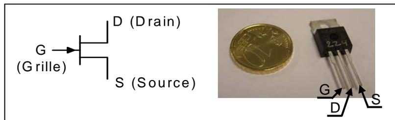
Figure 2-2 : Schéma électrique et boîtier du JFET SiC de type B.
