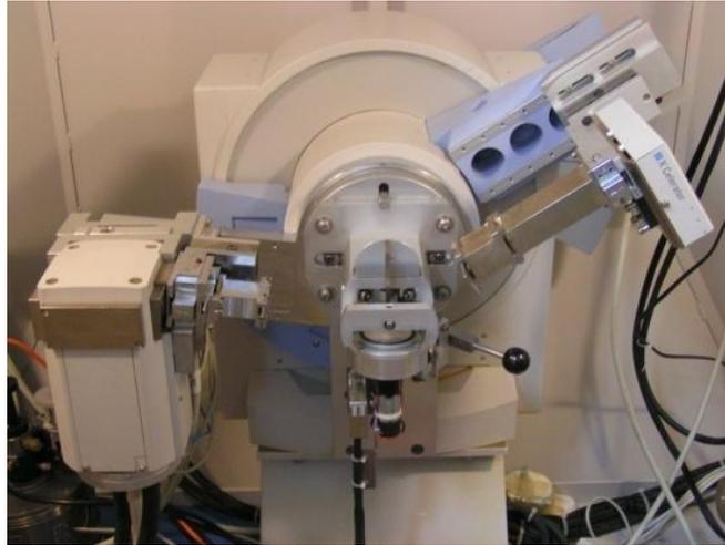
**Figure 19 : Diffractomètre X'Pert Pro (montage en réflexion)**
