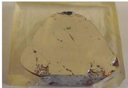
**Figure 74 : Phase Al<sub>2</sub>Cu après immersion 3 semaines dans H<sub>2</sub>SO<sub>4</sub> 200 g/l**
