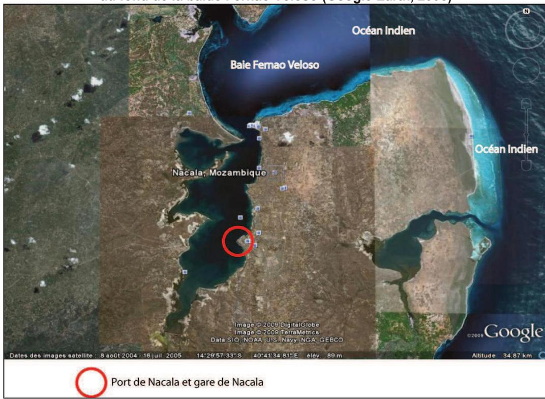
Image n° 2. La configuration du port de Nacala. On remarque que la gare est située dans l'enceinte du port, au plus près des quais maritimes. C'est pratiquement une constante en Afrique, le port est en lien direct avec le chemin de fer (Google Earth, 2005).
