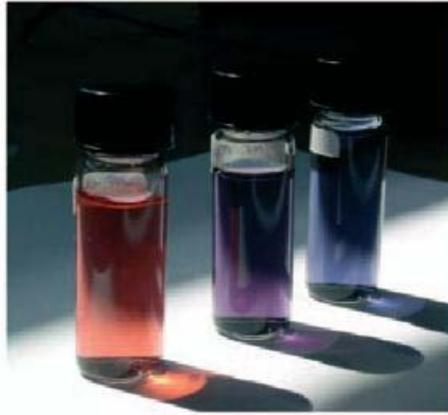
FIGURE 1.7 – Couleur de l’or à l’échelle du nanomètre : en rouge à gauche, solution contenant des nanoparticules d’or sphériques de 15 nm de diamètre; en violet solution identique mais contenant des particules agglomérées entre elles; et en bleu solution contenant des nanobâtonnets d’or de 5 nm [31]
