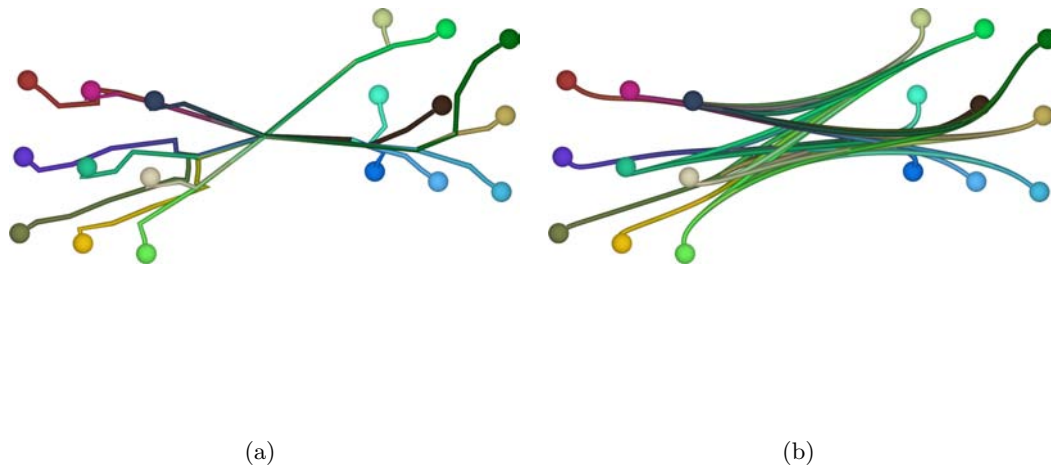
FIGURE 3.18: Illustrations du dessin avec regroupement d'arêtes en trois dimensions obtenues avec notre méthode pour le graphe K_{9,9} introduit à la Figure 3.14. Quatre itérations de notre processus de routage ont été effectuées pour le générer. Dans l'image (a), les arêtes sont rendues comme de simples poli-lignes. Dans l'image (b), la forme des arêtes a été lissée en utilisant des courbes de Bézier.
