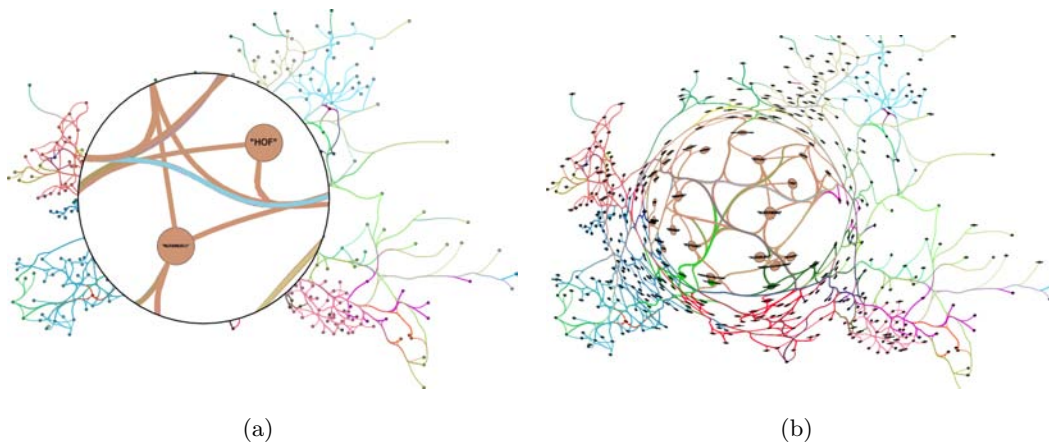
FIGURE 1.17: Techniques d'interaction loupe et Fisheye . (a) La loupe montre une vue détaillée sur une région locale du dessin. (b) Le Fisheye applique une déformation continue sur une petite région du dessin pour inspection locale.
