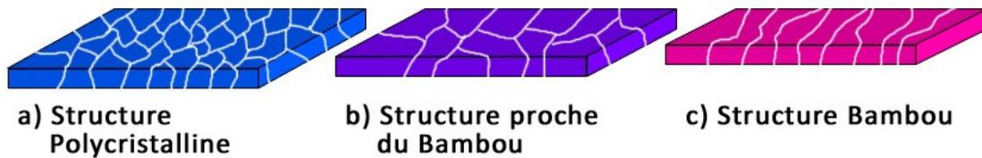
**Figure 1.7** : Différentes microstructures des pistes de métal : structure polycristalline (a), structure proche du bambou (b) et structure bambou (c).
