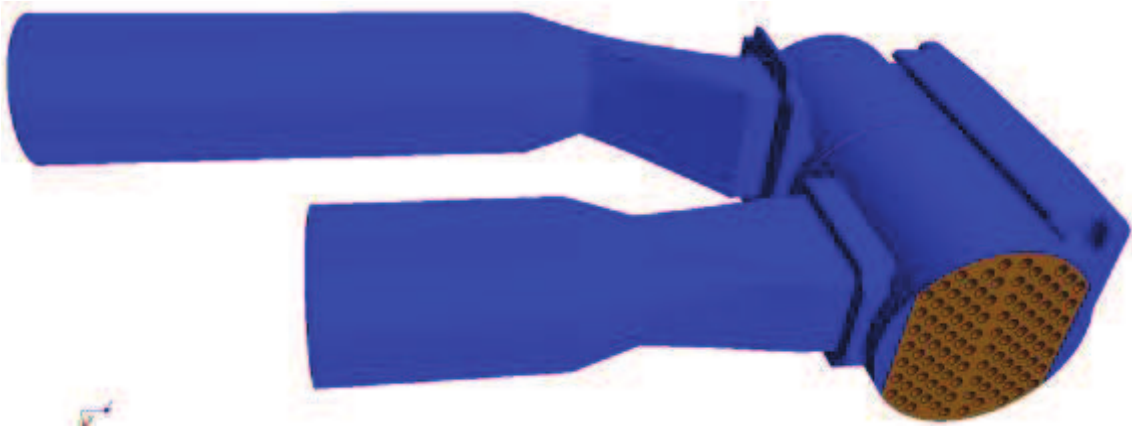
Figure 23. Géométrie de l'ERM. En bleu le volume fluide. En couleur rouille, le milieu poreux équivalent. L'entrée d'air s'effectue par le premier tube au-devant de l'image. L'air traverse la première passe de la gauche vers la droite de l'image. L'écoulement se retourne dans la boîte à air, traverse la seconde passe de la droite vers la gauche et ressort par le deuxième tube au second plan.
