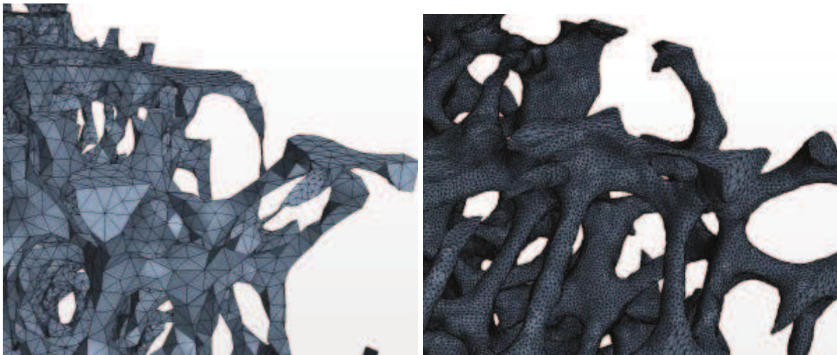
Figure 74. Maillage de la surface d'une ERG20PPI reconstruite à partir de tomographies. A gauche un maillage « lâche » qui ne capture pas entièrement la phase solide. A droite un maillage fin capturant correctement la phase solide mais comportant plus de 2000000 de mailles.
