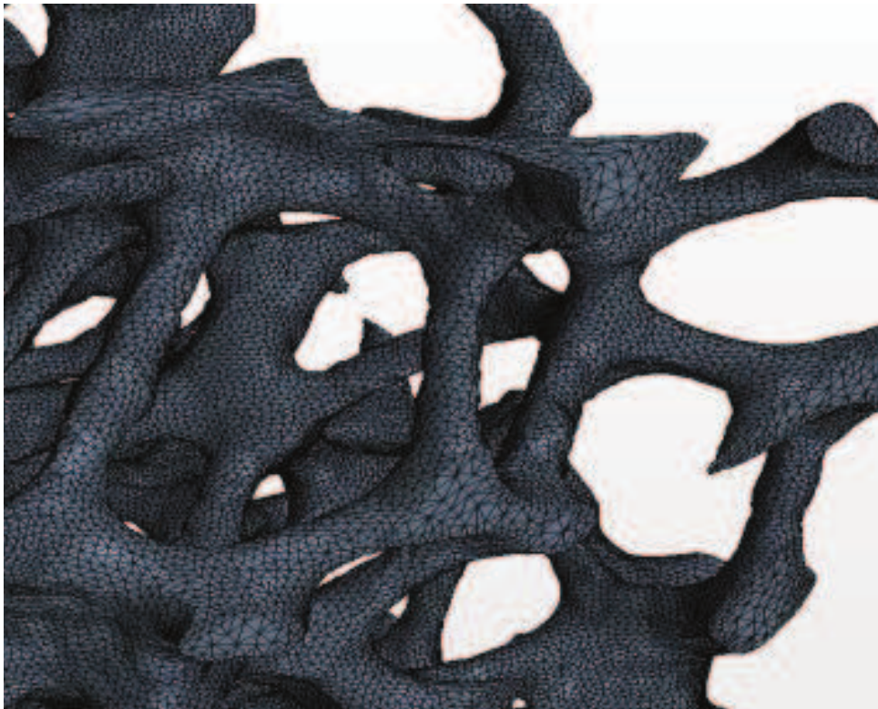
Figure 55. Reconstruction 3D d'une mousse réelle ERG20 PPI et maillée par StarCCM+.
