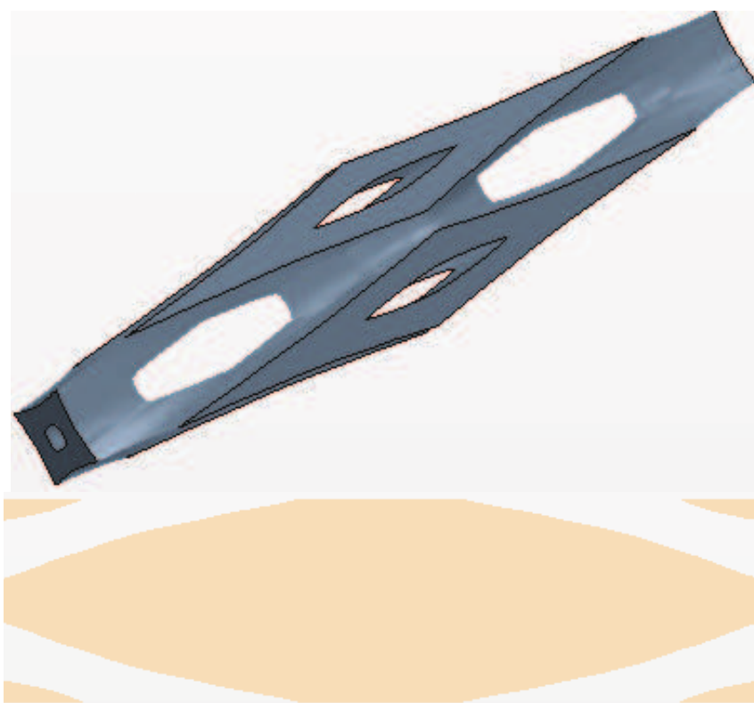
Figure 61. Cellule de Kelvin étirée. En haut : vue isométrique d'une cellule de Kelvin étirée d'un facteur 3. En bas : vue d'une section plane de cette même mousse.
