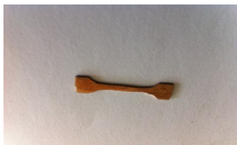
Figure 23 Plaque de bronze phosphoreux (Longueur(L)=25mm, épaisseur(t)=0,8mm, largeur=2mm)
