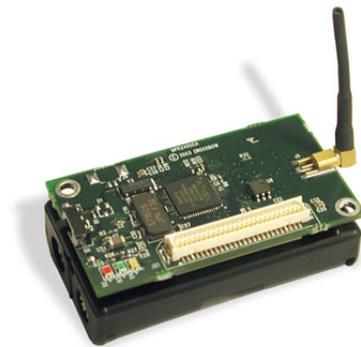
FIGURE 1.2 – Exemple d'un capteur Micaz
