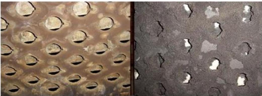
Figure 7 : Exemple de corrosion sur un plateau de distillation de raffinerie.<sup>12</sup>
