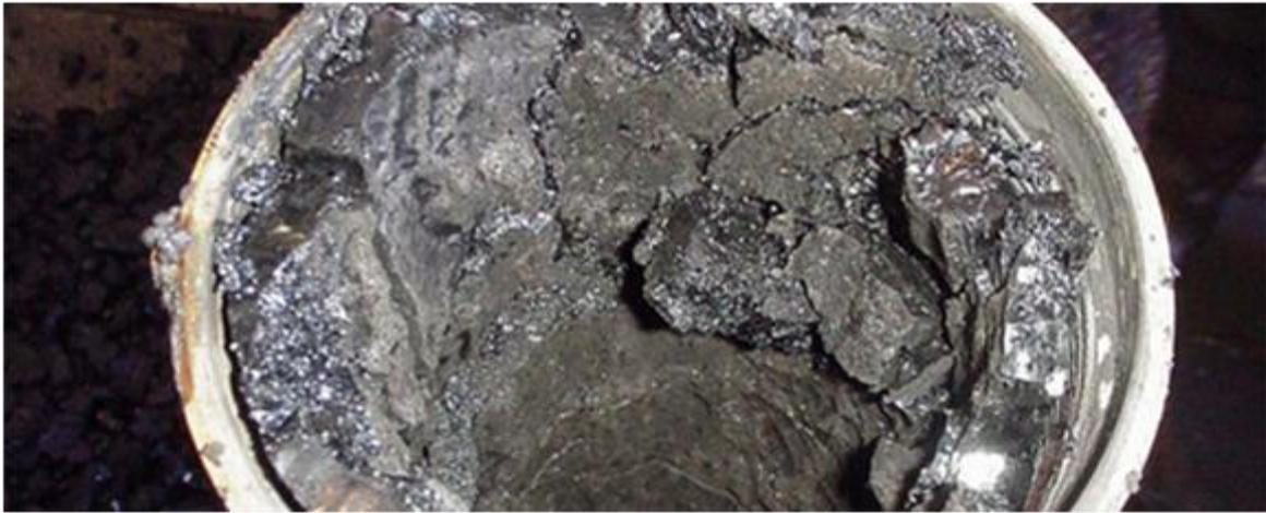
Figure 3 : Exemple d'une canalisation bouchée partiellement par un dépôt d'asphaltènes<sup>9</sup>.
