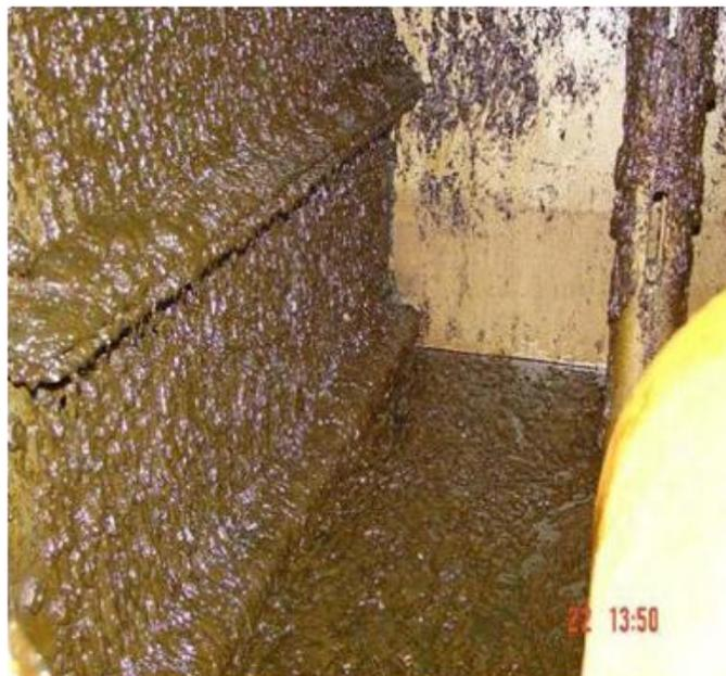
Figure 4 : Unité de séparation en mer du nord bouchée par un dépôt de naphthénates<sup>10</sup>.
