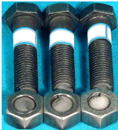
FIGURE 1.39 – Rupture de boulons en fatigue, au premier filet en prise, [Majzoobi et al. , 2005]
