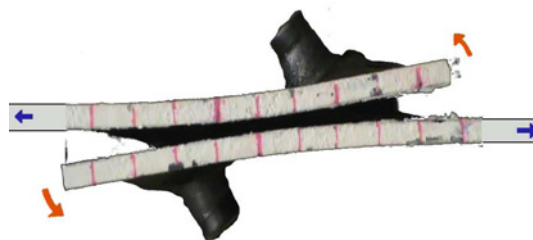
FIGURE 2.62 – Image figée d'une vidéo réalisée pendant un essai de simple cisaillement, avec un ratio t/d de 0,4
