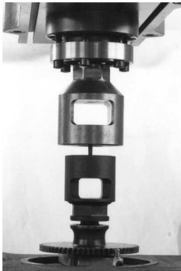
FIGURE 1.38 – Essai de fatigue sur fixation sur vibrophore, [Massol, 1994]
