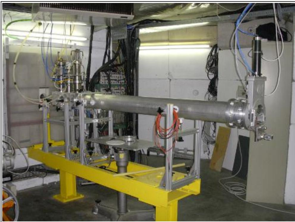
**Figure 44 : Photographie de la sortie de la ligne protons du cyclotron de l'UCL**
