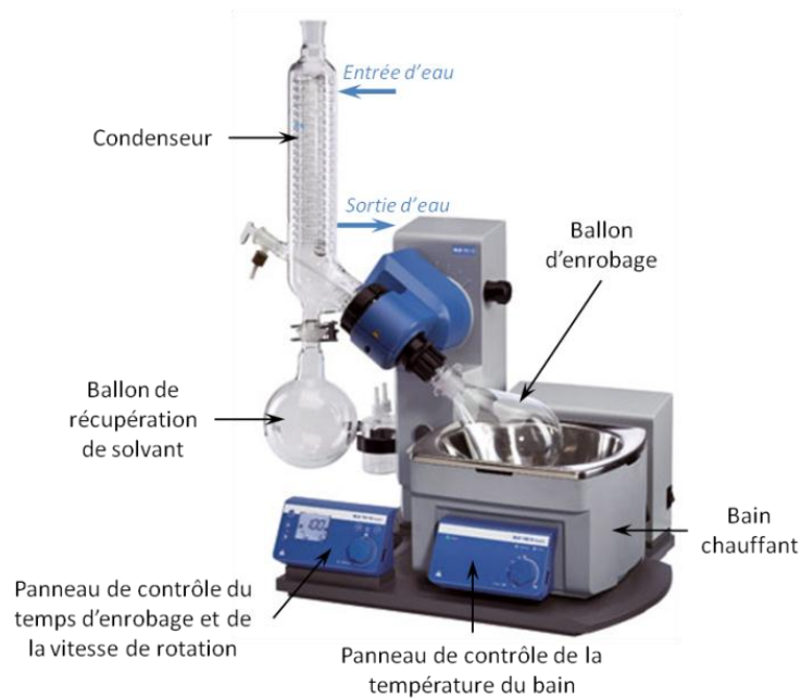
Figure 2.1. Schéma de fonctionnement de l'évaporateur rotatif
