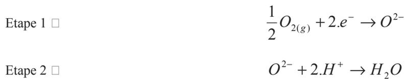
**Fig. 11. Représentation schématisée du mécanisme de réduction de l'oxygène à la cathode dans le cas d'un composite céramique conducteur mixte  $e^{-} / H^{+}$**
