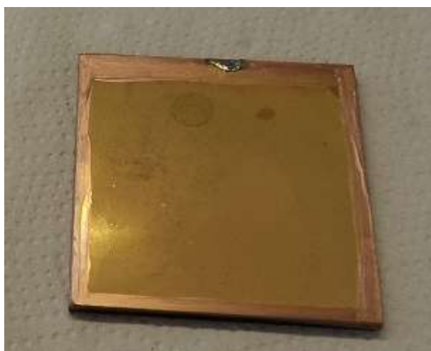
Figure 66 Photographies d'une électrode poreuse de 36 \text{ cm}^2 faite à partir d'un cristal colloïdal assemblé par LB.
